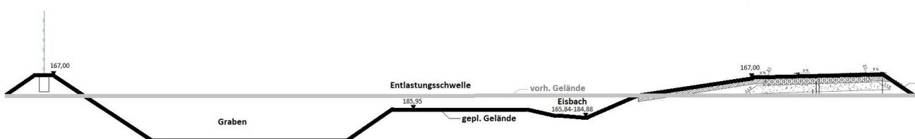
Abbildung 7: Querschnitt der Geländeänderung im Bereich des Eisbach (© Erftverband und Stadt Meckenheim 2018, verändert ISR)
