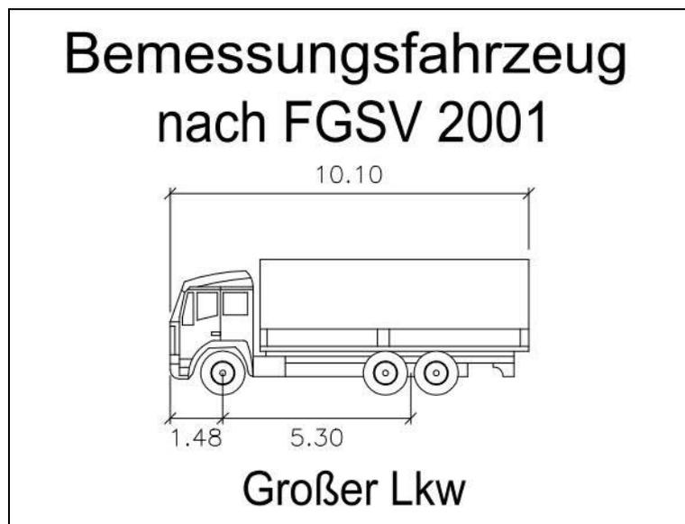
Abbildung 3: Bemessungsfahrzeug „großer Lkw“ (vgl. FGSV, 2001)
