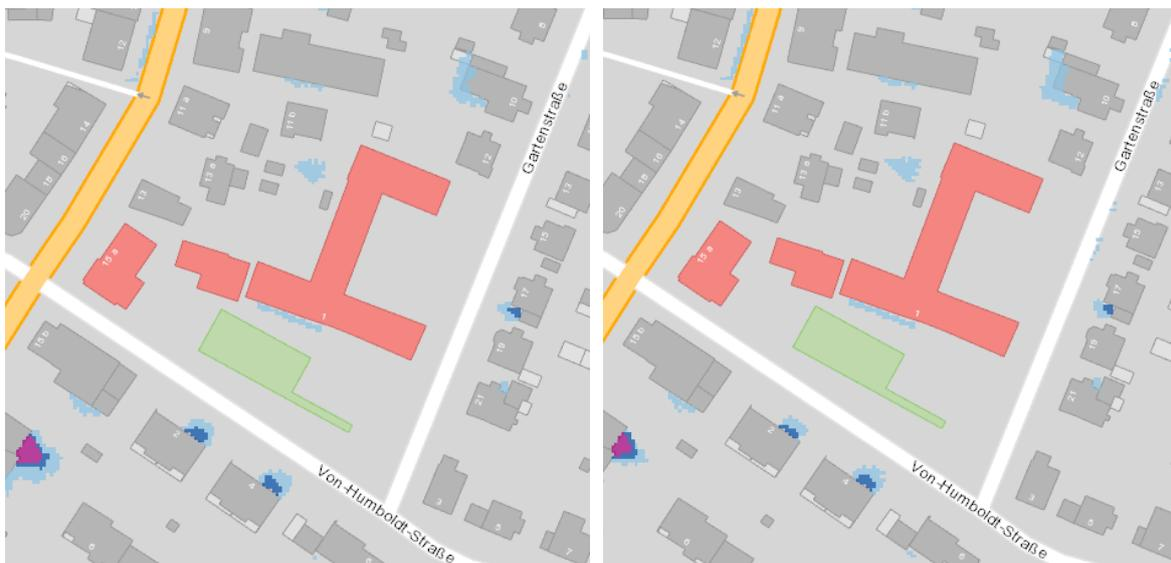
Abbildung 5: Auszug aus der Starkregengefahrenkarte der Stadt Löhne (links außergewöhnliches Ereignis, rechts extremes Ereignis); hellblaue Flächen kennzeichnen einen Wasserstand von 0,1-0,5 m, blaue Flächen einen Wasserstand von 0,5-1,0 m und lila Flächen einen Wasserstand von über 1,0 m (Quelle: Stadt Löhne)
