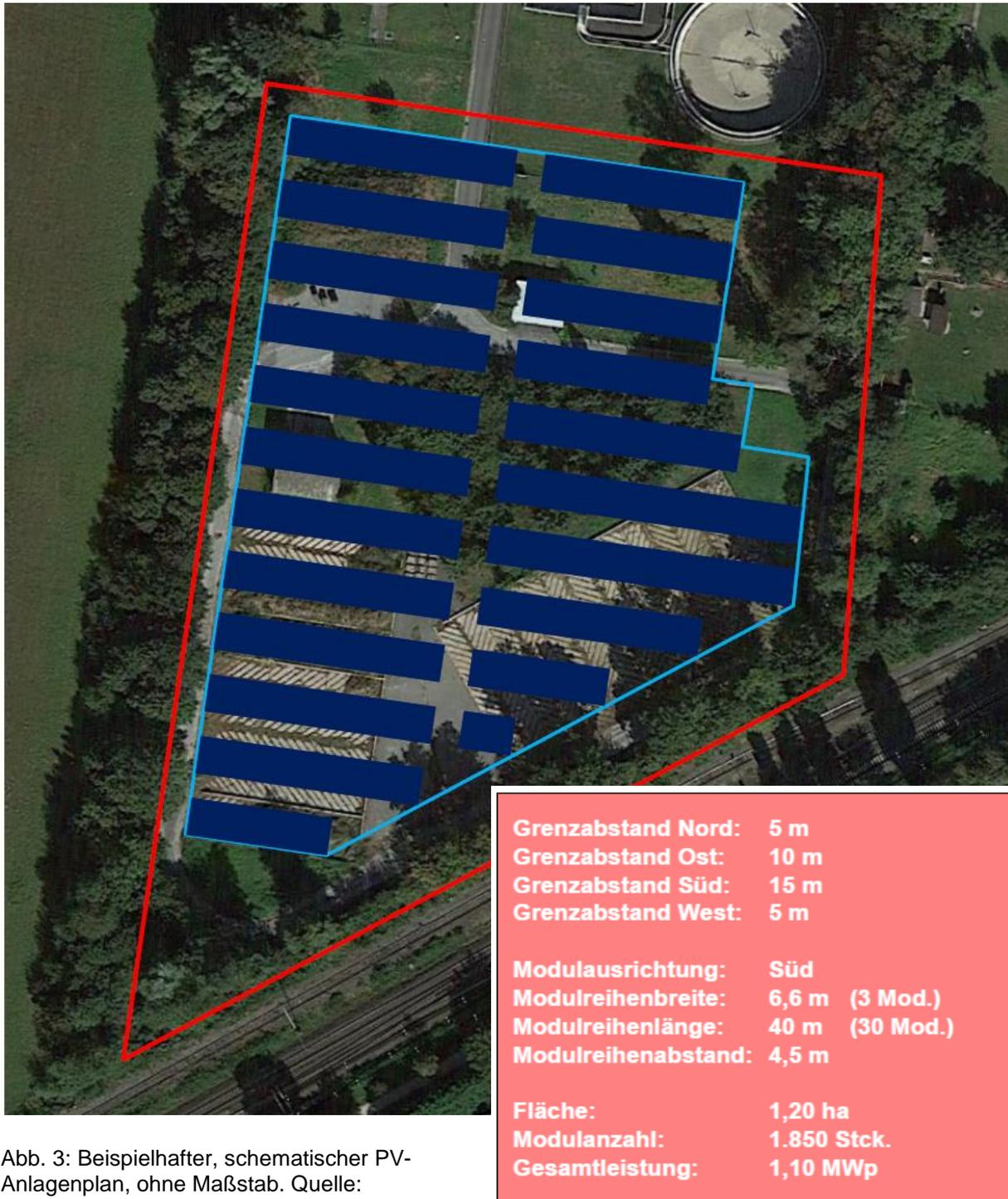
Abb. 3: Beispielhafter, schematischer PV-Anlagenplan, ohne Maßstab. Quelle: Stadtwerke Lippstadt, 2022
