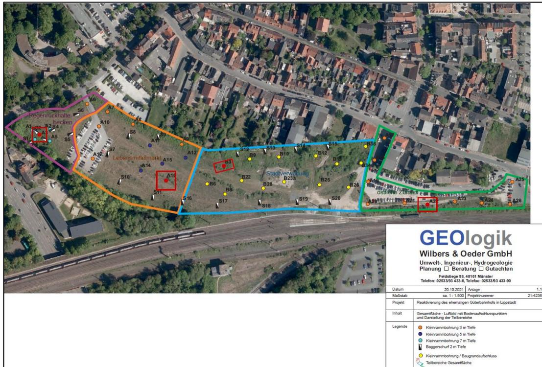
Abb. 13: Bewertung Boden - Altlasten: Übersicht Bohrungen und Baggerschürfen (Geologik, 2021)
