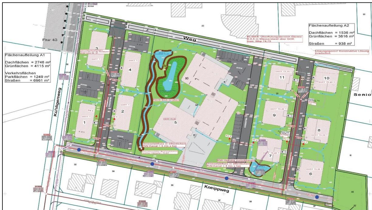
Abbildung: Lageplan Entwässerungskonzeption, ohne Maßstab (Quelle: Ingenieurbüro Mirko Molt)
