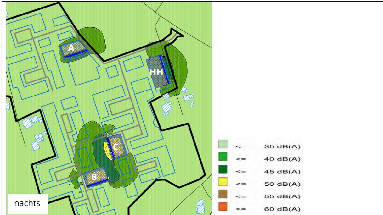
Abbildung 6: Lärmbelastung im Plangebiet durch Anlagenlärm im 2. OG mit geschlossenen Fassadenteilen, ohne Maßstab (Quelle: Akus GmbH, Anlage 6)
