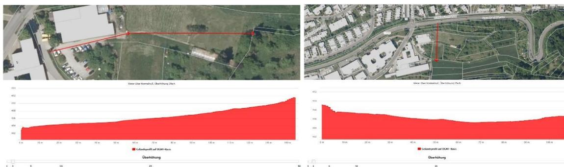
Abb. 5: Hangprofil von Ost nach West (links) und Hangprofil von Süd nach Nord (rechts). Quelle: LUBW
