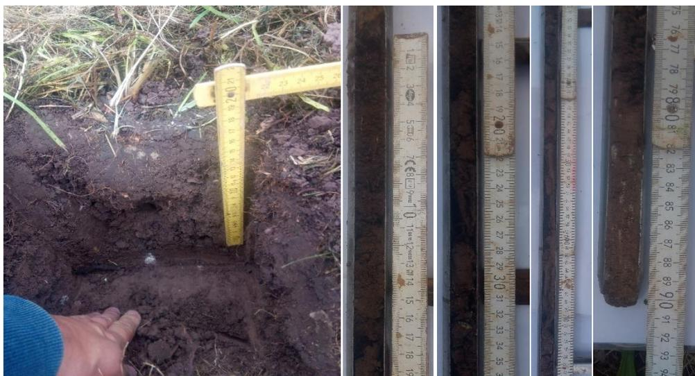
Abb. 2: Bodentyp Braunerde-Pelosol; Spatengrube sowie Bohrstocksequenzen als Beispiel an Profil 2.
