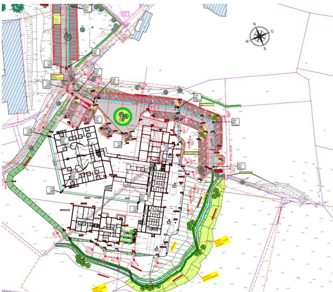
Abb. 8: *geplanter Gewässerverlauf nach Umlegung, Ing. Büro Schmidt, Olpe, September 2018*
