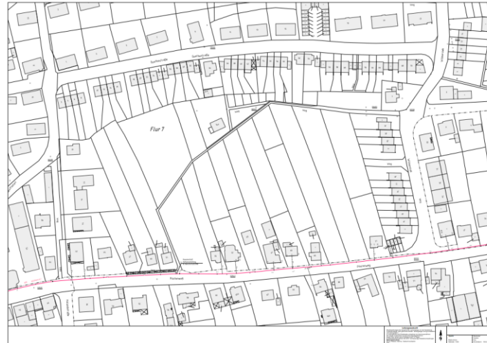
Abb. Bestandsplan Erdgashochdruckleitung
