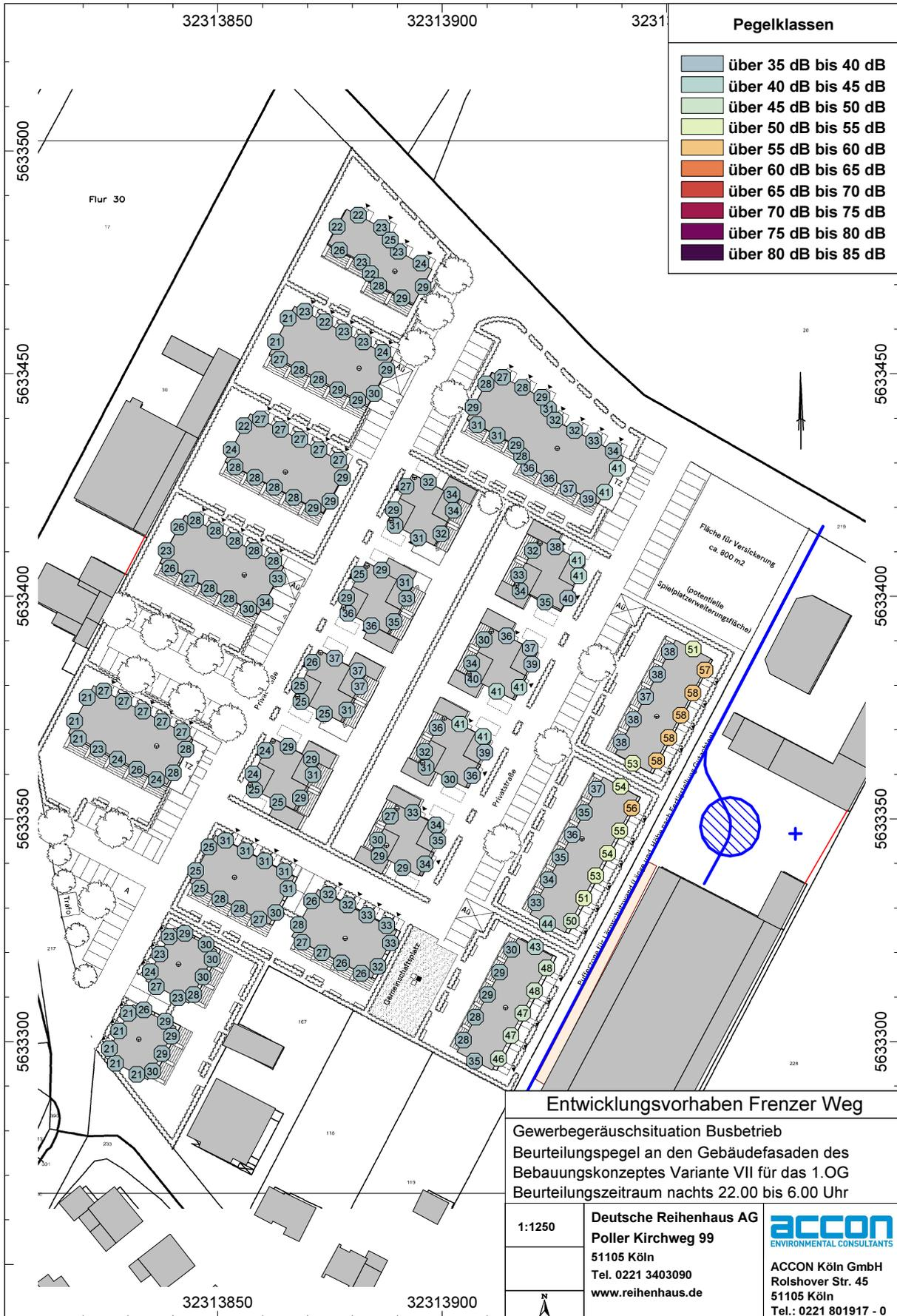
**Abb. 12** Gebäudelärmkarte für das erste Obergeschoss in Variante IV ohne Schallschutzmaßnahme, nachts
