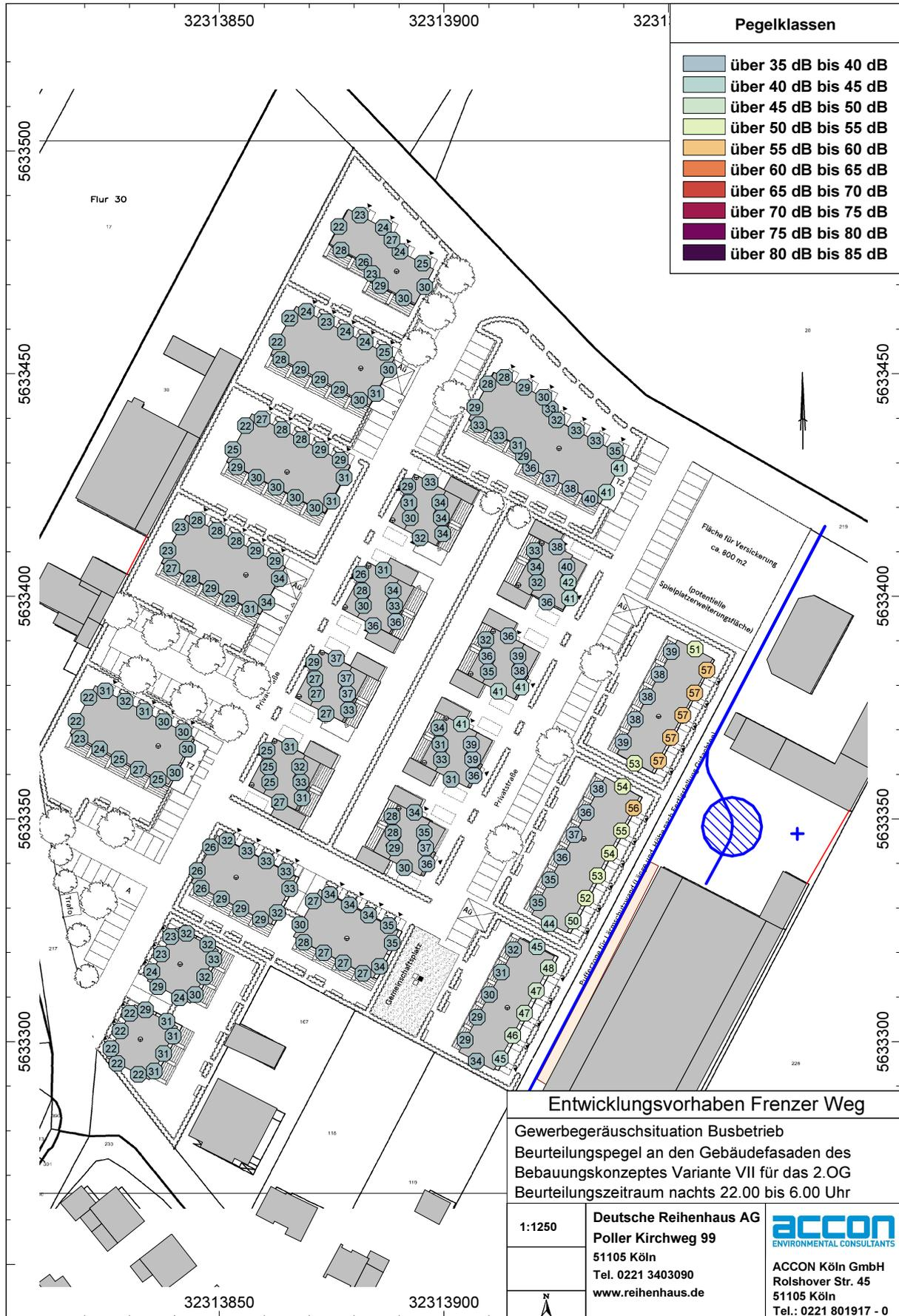
**Abb. 13** Gebäudelärmkarte für das zweite Obergeschoss in Variante VII ohne Schallschutzmaßnahme, nachts
