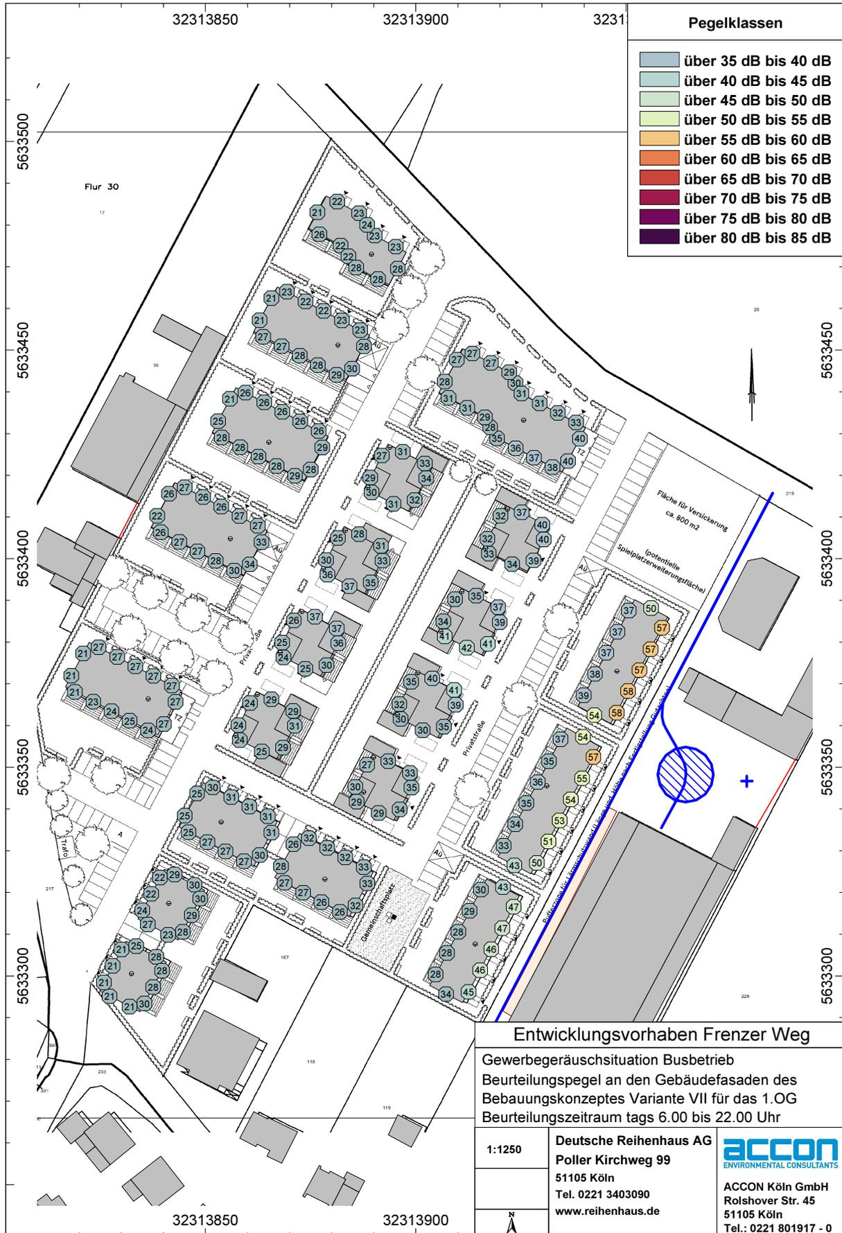
**Abb. 9** Gebäudelärmkarte für das erste Obergeschoss in Variante VII ohne Schallschutzmaßnahme, tags
