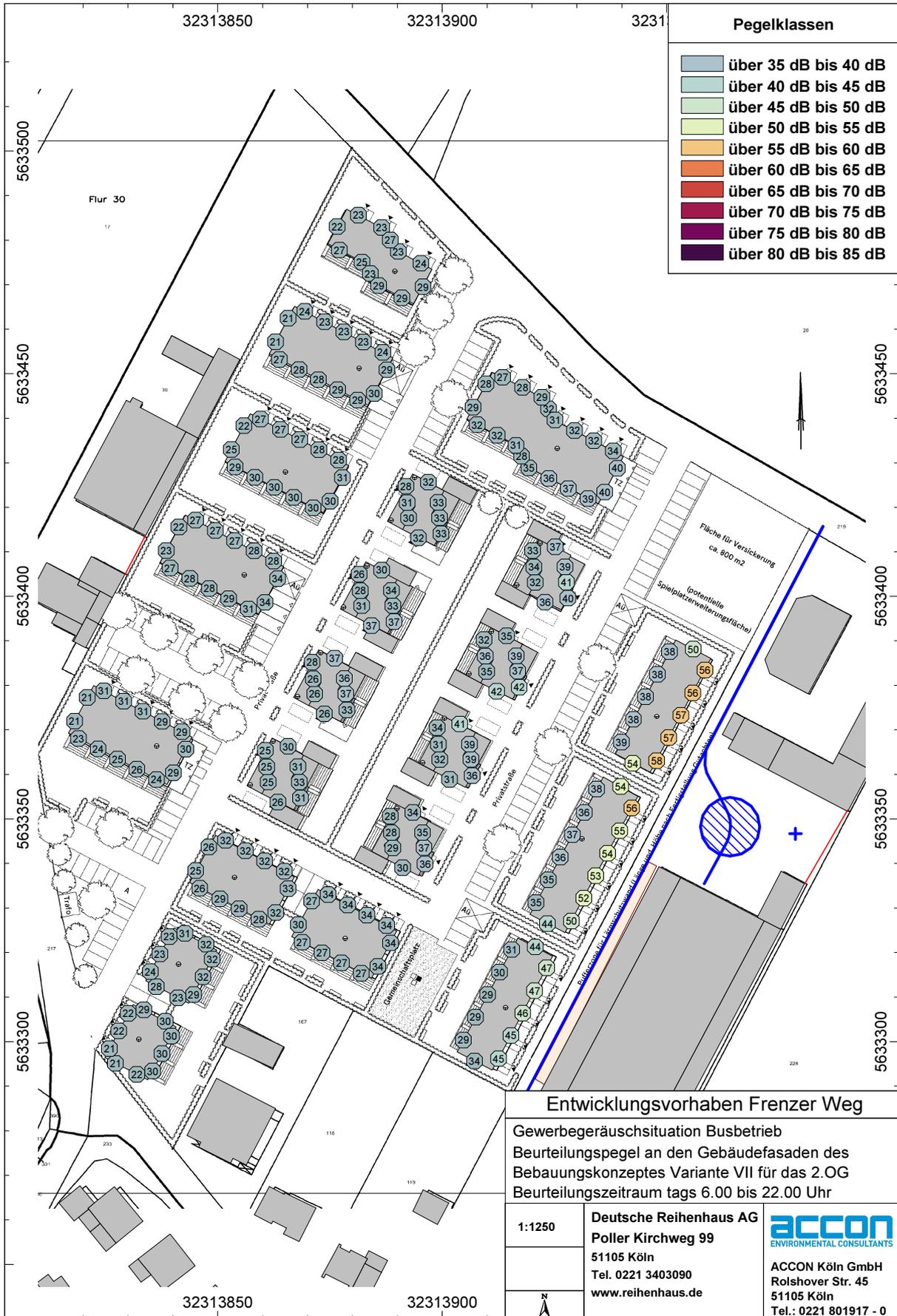
**Abb. 10** Gebäudelärmkarte für zweite Obergeschoss in Variante VII ohne Schallschutzmaßnahme, tags
