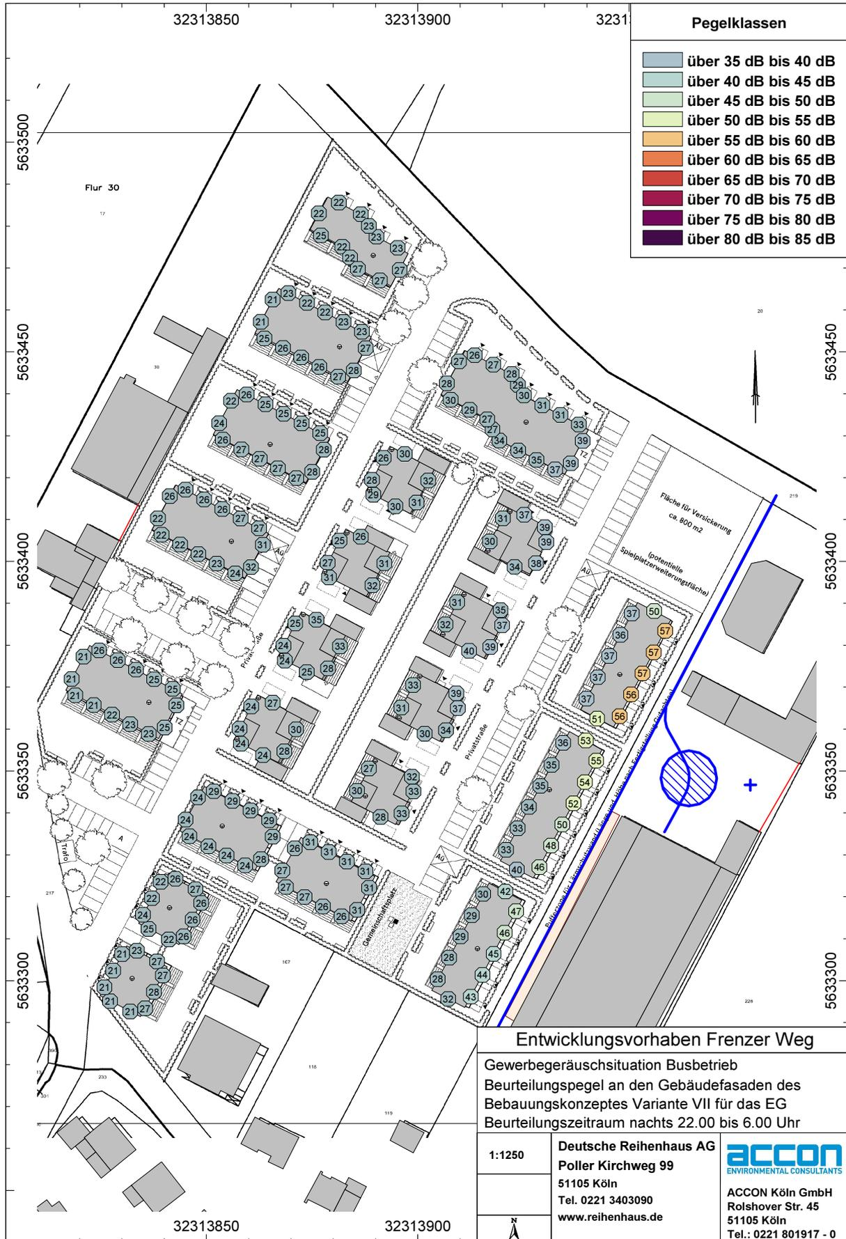
**Abb. 11** Gebäudelärmkarte für das Erdgeschoss in Variante VII ohne Schallschutzmaßnahmen, nachts
