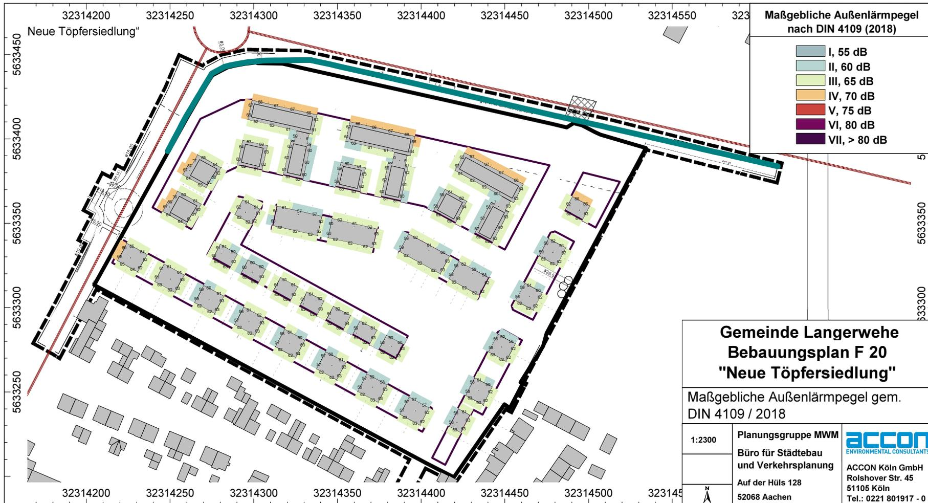
Abb. 7.1 Darstellung der maßgeblichen Außenlärmpegel gem. DIN 4109
