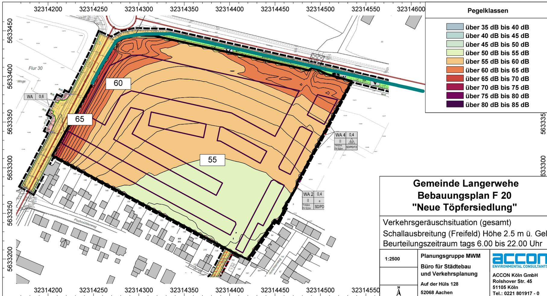
**Abb. 4.2.1** Darstellung der Geräuschimmissionen in Höhe 2,5 m (EG) über Gelände, Verkehrsgerauschemissionen tags
