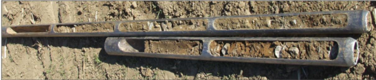
Abb. 3: Rammkernsonden „RKS 5“ (unten: 0,00-1,00m; oben: 1,00-2,60m)
