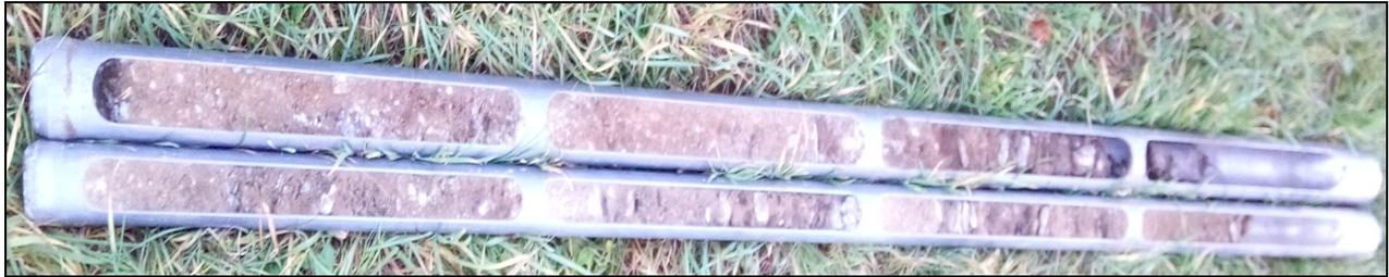
**Abb. 3: Rammkernsonden „RKB 4“ (oben: 0,00-2,00m; unten: 2,00-4,00m)**
