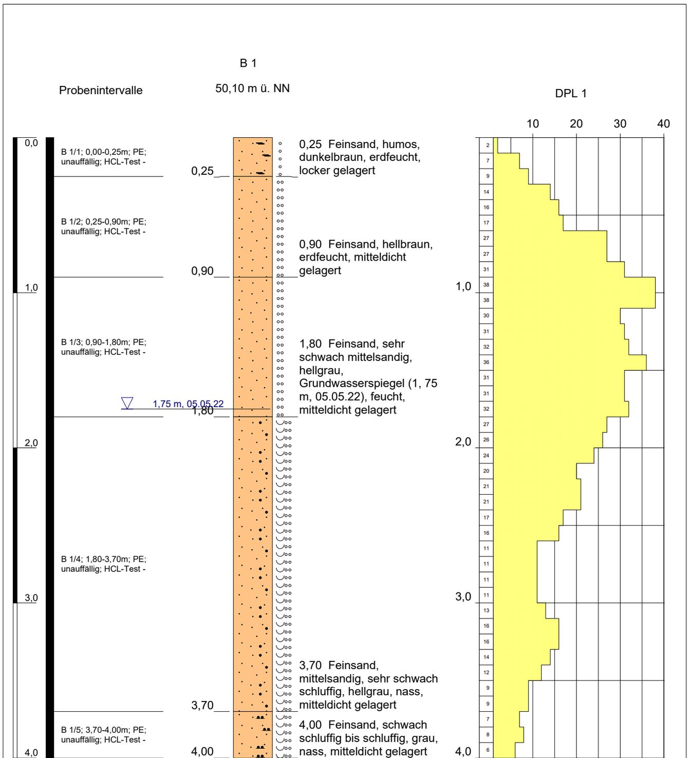
Bohrdurchmesser: 50 / 40 mm
