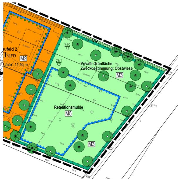
Abbildung 13: Fläche für die Rückhaltung und Versickerung von Niederschlagswasser gem. B-Plan
