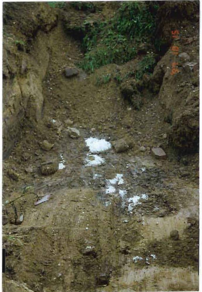
Im hinteren Teil der Schürfe 5 stand unter einer 0,8 m mächtigen Schicht aus humosem, schwach schluffigem Sand von 0,8 bis 1,0 m hellbrauner, kiesiger Sand an. Die Sohle lag hier auf + 55,94 mNN. Im dem nachfolgenden Foto ist auf der linken Bildhälfte im Bodenanschnitt die dunkle Verfärbung über dem in der Sohle anstehenden hellen Sand zu erkennen. Knochen oder Knochenreste konnten nicht festgestellt werden.
