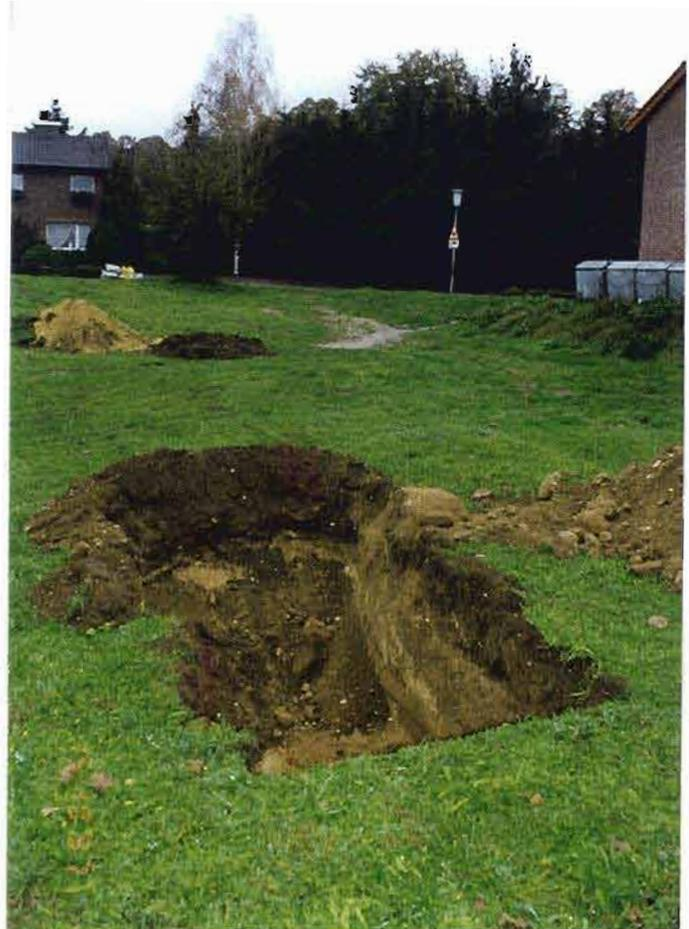
Die **Schürfe 3** liegt im Bereich der ehemaligen Tötungsbucht für Schweine (Bohrung B 1). In der 1 m tiefen Schürfe (Grubensohle auf + 56,44 mNN) stand unter einer 0,4 m mächtigen Auffülle aus dunkelbraunem, humosem, schwach schluffigem Sand mit wenig Ziegelanteil der gewachsene hellbraune, kiesige Sand an.
