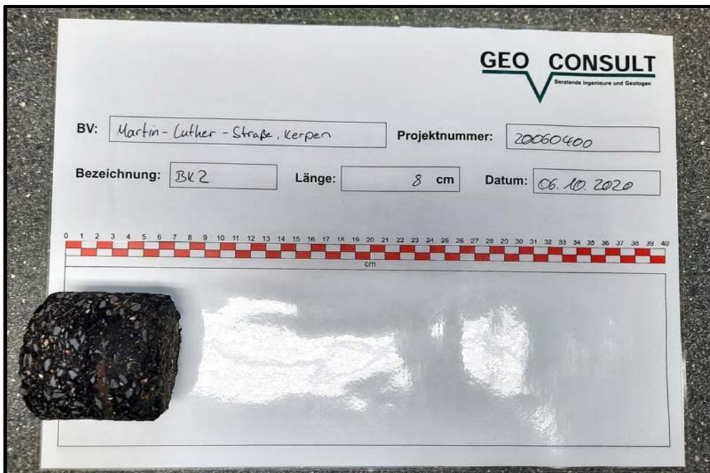
Abb. 2: Asphaltbohrkern BK 2
