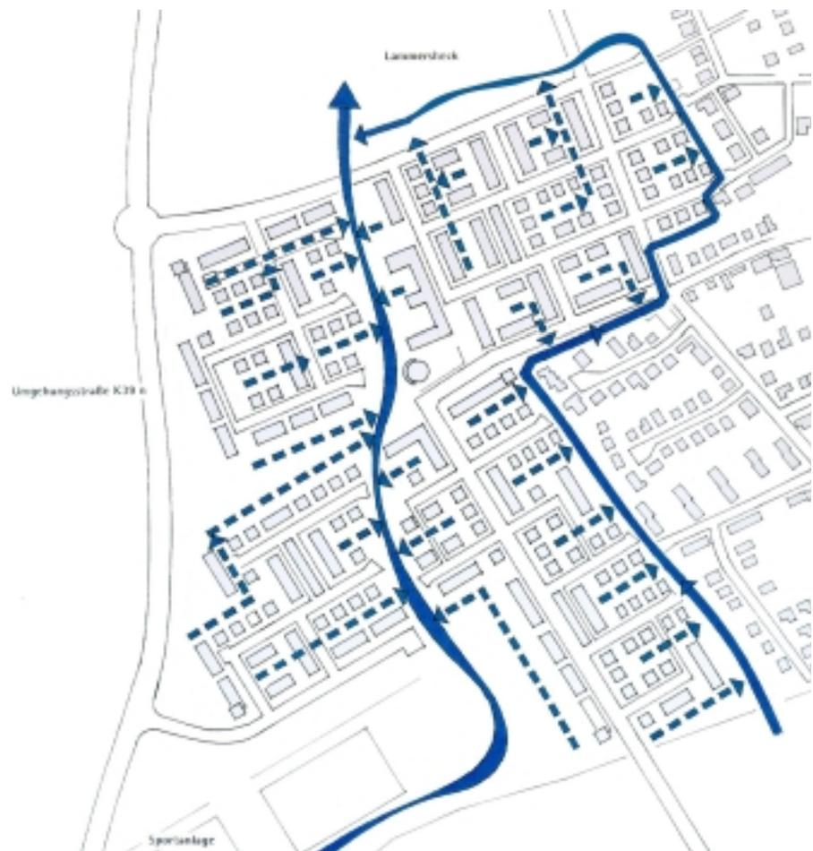
Abbildung 27: Schematische Darstellung der Regenwasserversickerung
