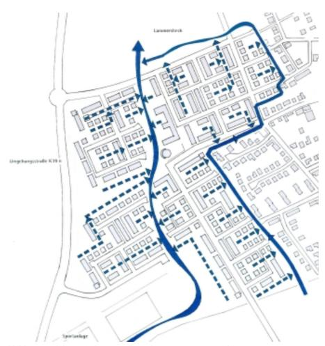
Abbildung 27: Schematische Darstellung der Regenwasserversickerung
