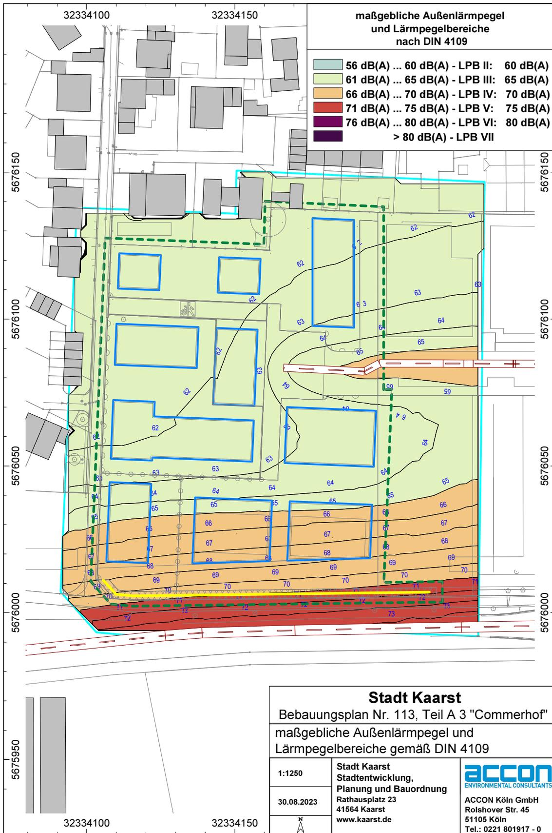
Abb. 5.1 maßgebliche Außenlärmpegel und Lärmpegelbereiche gemäß DIN 4109
