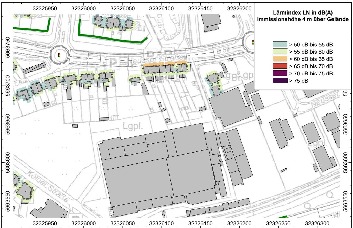
**Abb. 11.5.13** Lärmindex  $L_N$  ab 50 dB(A) unter Berücksichtigung der derzeitigen Geschwindigkeiten nachts im Bereich des Kreisverkehrs - Neusser Straße - Tempo 50 gemäß CNOSSOS
