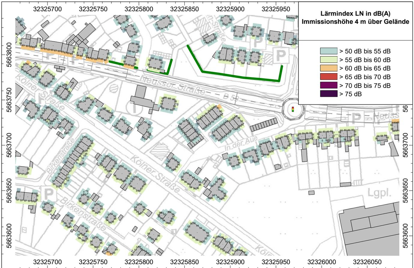
**Abb. 11.5.12** Lärmindex  $L_N$  ab 50 dB(A) unter Berücksichtigung der derzeitigen Geschwindigkeiten nachts im Bereich des Kreisverkehrs - Neusser Straße - Tempo 50 gemäß CNOSSOS
