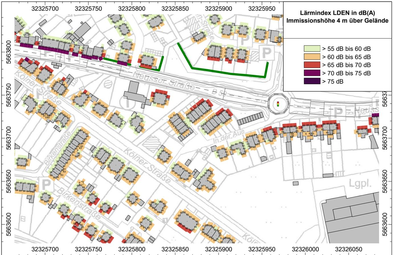
**Abb. 11.5.6** Lärmindex  $L_{DEN}$  ab 55 dB(A) unter Berücksichtigung der derzeitigen Geschwindigkeiten tags im Bereich des Kreisverkehrs - Neusser Straße - Tempo 50 gemäß CNOSSOS
