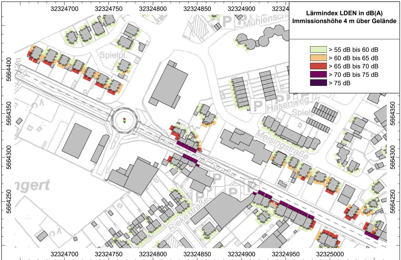
**Abb. 11.5.2** Lärmindex L<sub>DEN</sub> ab 55 dB(A) unter Berücksichtigung der derzeitigen Geschwindigkeiten tags im Bereich der Odenkirchener Straße - Tempo 50 gemäß CNOSSOS
