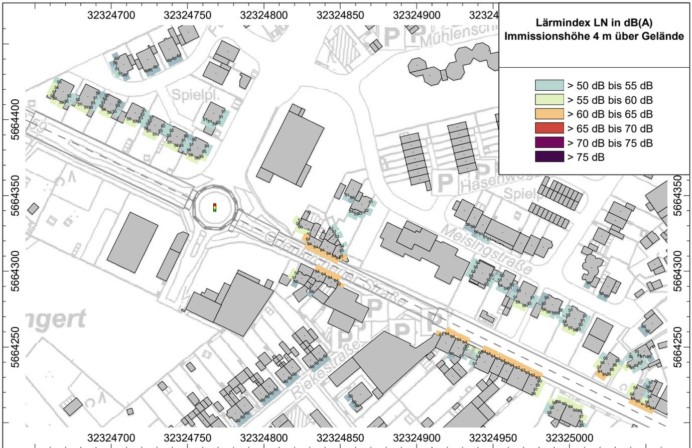
**Abb. 11.5.8** Lärmindex  $L_N$  ab 50 dB(A) unter Berücksichtigung der derzeitigen Geschwindigkeiten nachts im Bereich der Odenkirchener Straße - Tempo 50 gemäß CNOSSOS
