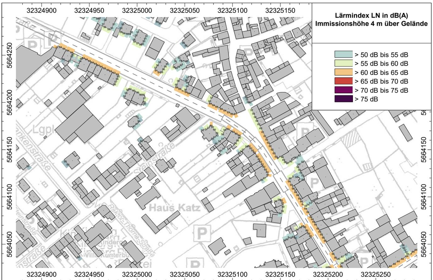
**Abb. 11.5.9** Lärmindex  $L_N$  ab 50 dB(A) unter Berücksichtigung der derzeitigen Geschwindigkeiten nachts im Bereich der Odenkirchener Straße - Tempo 50 gemäß CNOSSOS
