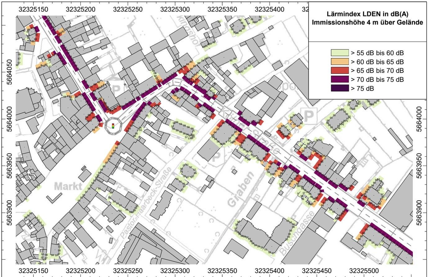
**Abb. 11.5.4** Lärmindex  $L_{DEN}$  ab 55 dB(A) unter Berücksichtigung der derzeitigen Geschwindigkeiten tags im Bereich Odenkirchener Str. Markt und Kölner Str. - Tempo 50 gemäß CNOSSO5
