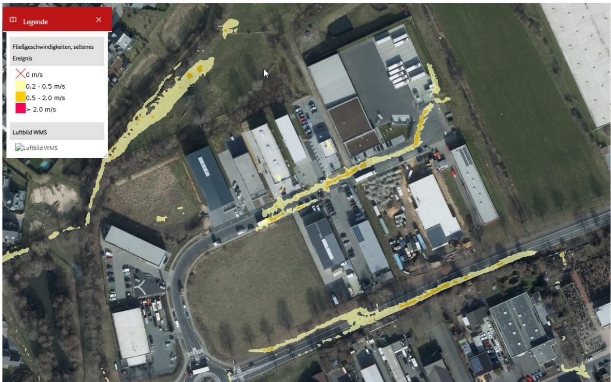
Abbildung 9: Prognostizierte Fließgeschwindigkeiten bei einem seltenen Ereignis
