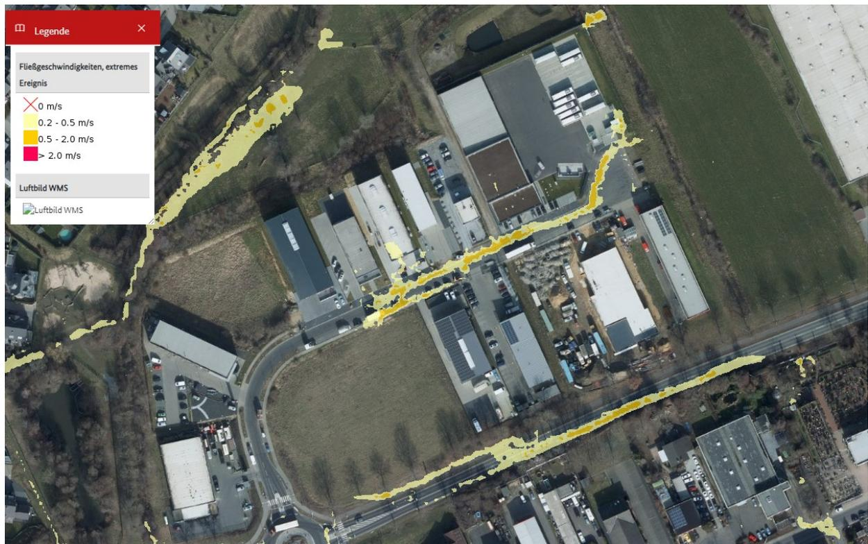
Abbildung 10: Prognostizierte Fließgeschwindigkeiten bei einem extremen Ereignis
