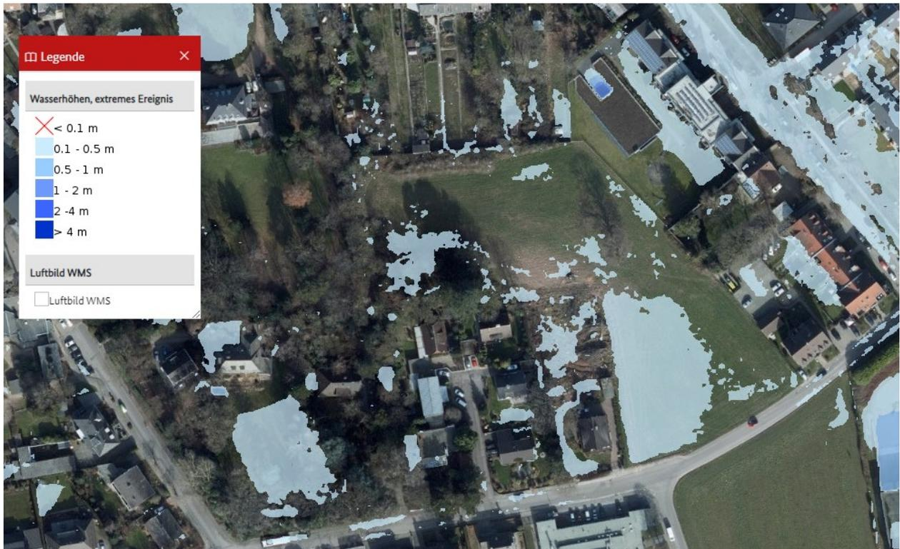
Abbildung 8: Prognostizierte Wasserhöhen für ein extremes Ereignis
