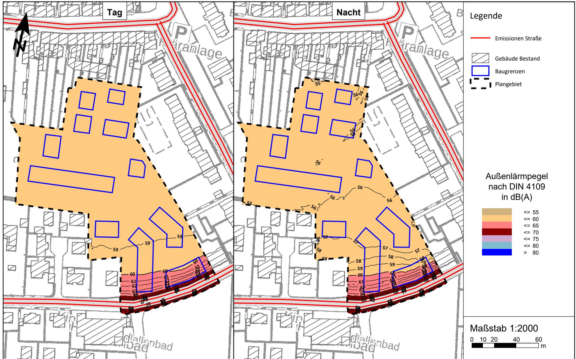
Anlage 11.2: Flächenhafte Kennzeichnung der maßgeblichen Außenlärmpegel nach DIN 4109:2018, 1. Obergeschoss
