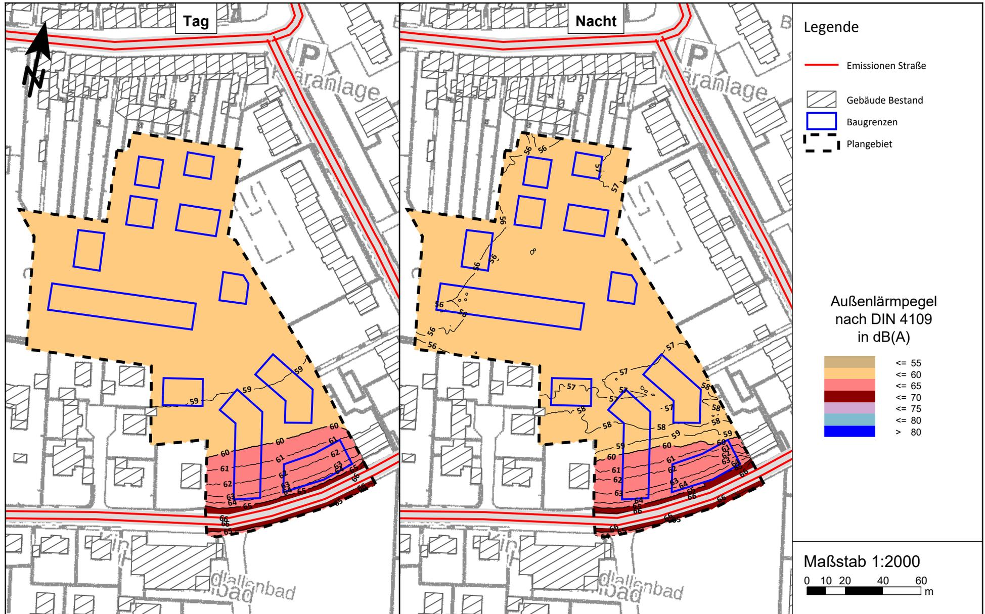
Anlage 11.3: Flächenhafte Kennzeichnung der maßgeblichen Außenlärmpegel nach DIN 4109:2018, 2. Obergeschoss
