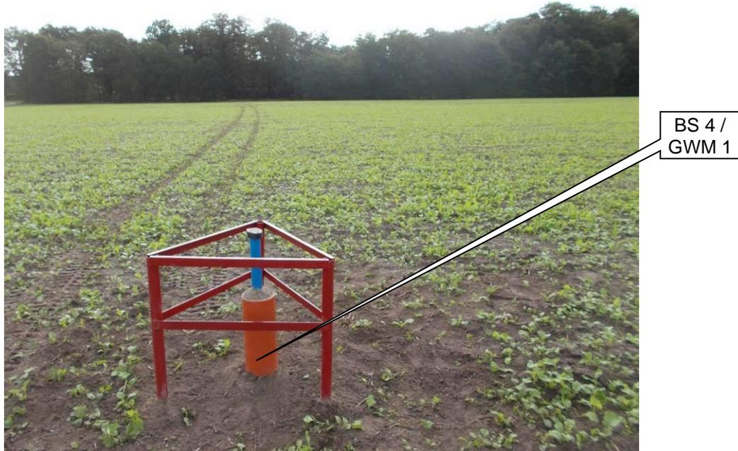
**Foto 5:** Blickrichtung ~ SO; Bereich der BS 4, ausgebaut zur GWM 1 (Markierung)
