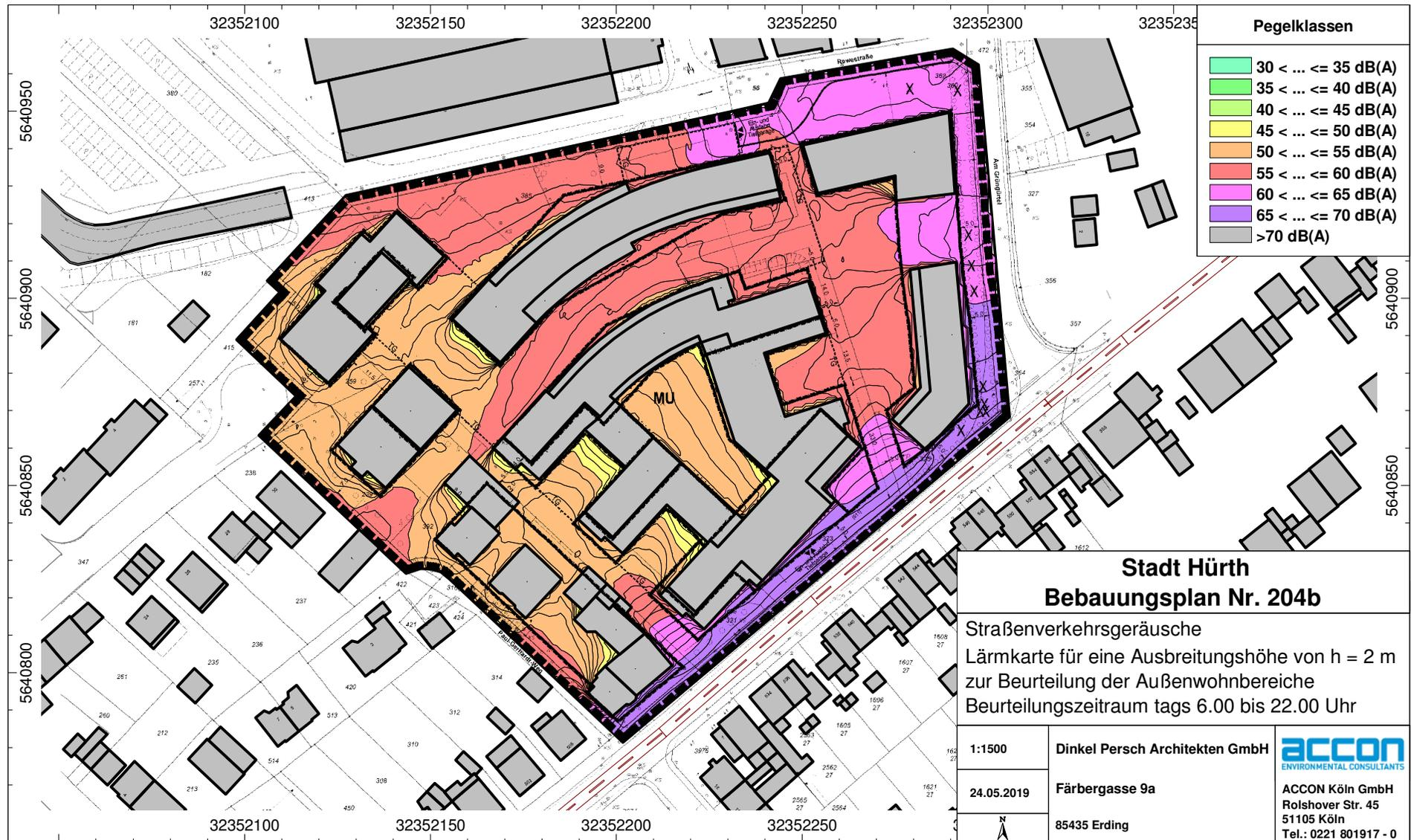
**Abb. 5.2.1.9** Lärmkarte für eine Ausbreitungshöhe von  $h = 2\text{ m}$  ü. Gel. zur Beurteilung der Außenwohnbereiche
