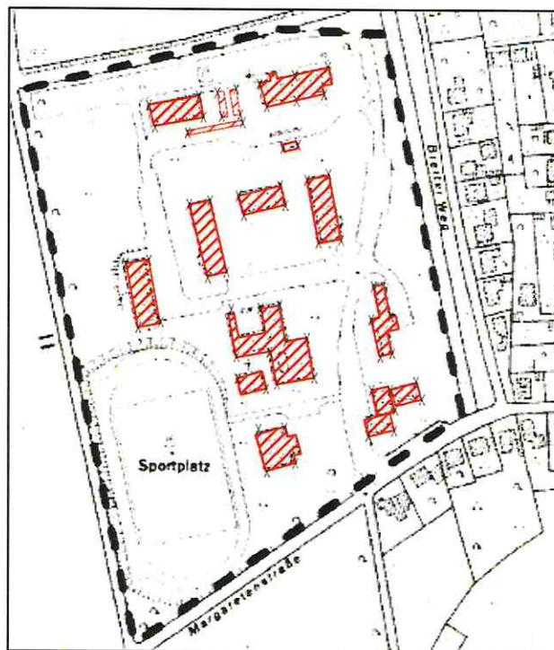
Abbildung 3: Lageplan der Bearbeitungsfläche BV Wohnpark Emscherquelle in Holzwickede mit Darstellung der abzureißenden Bestandsbebauung.
