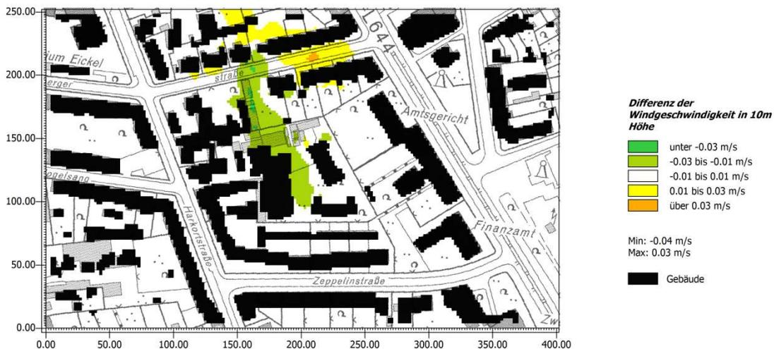
Abb. 20 Differenzen Klimaangepasstes Szenario zum Plan-Szenario: Wind bei Anströmung aus Südsüdost um 15 Uhr
