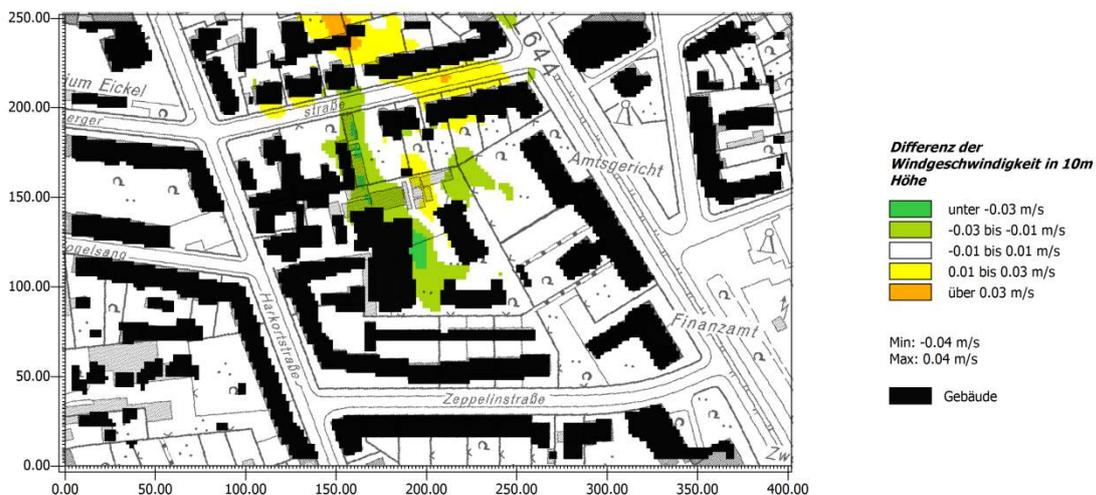
Abb. 21 Differenzen Klimaangepasstes Szenario zum Plan-Szenario: Wind bei Anströmung aus Südsüdost um 0 Uhr
