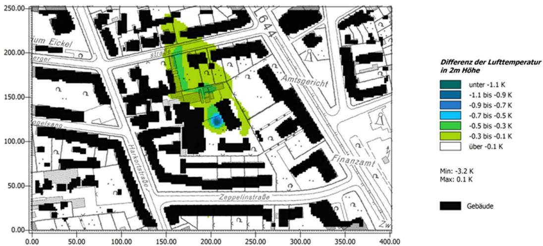
Abb. 24 Differenzen Klimaangepasstes Szenario zum Plan-Szenario: Lufttemperaturen um 15 Uhr
