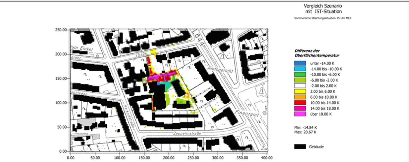
Abb. 8 Differenzen zum Plan-Szenario: Oberflächentemperaturen um 15 Uhr
