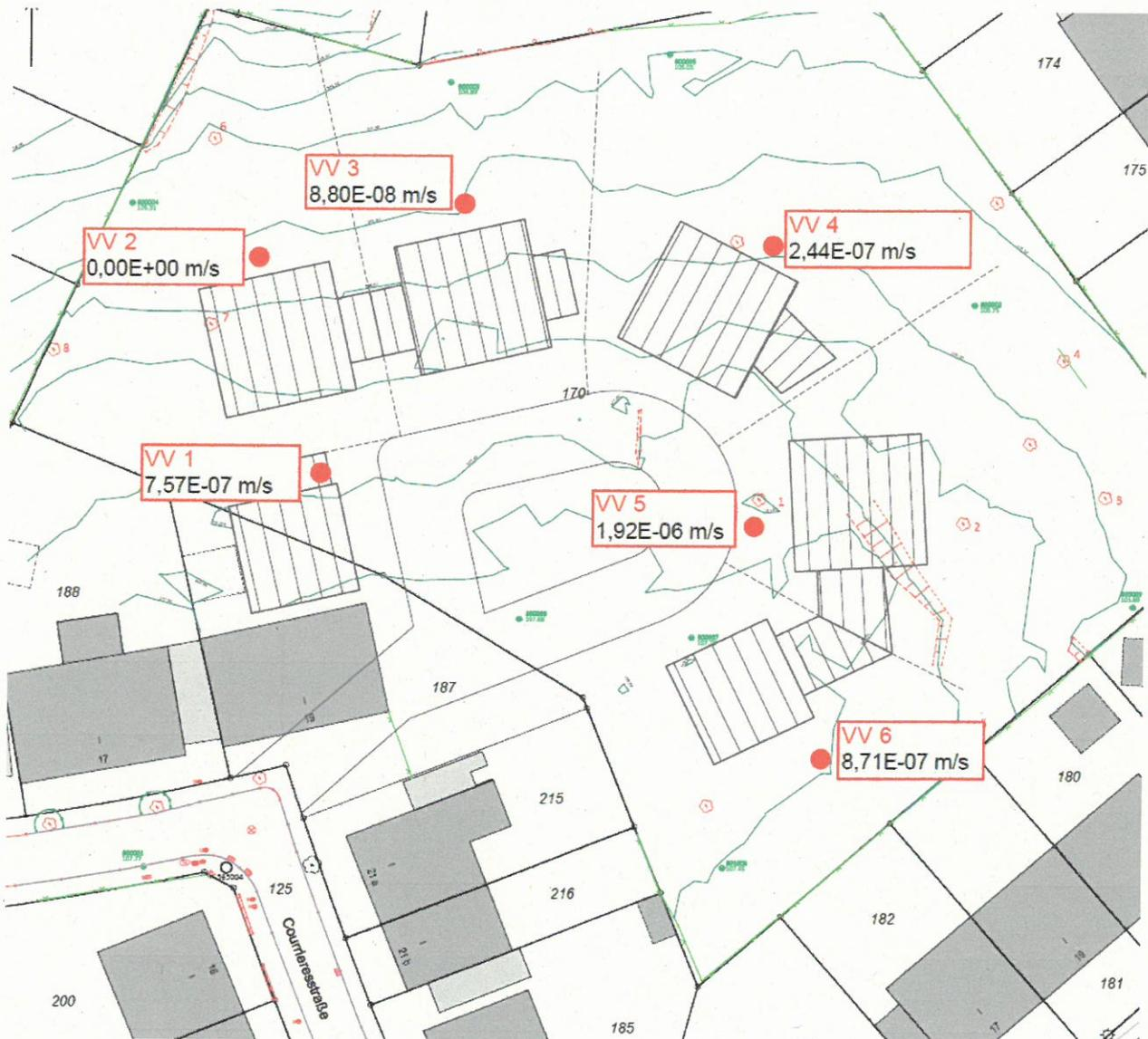
Abbildung 2: Untersuchungsgebiet mit Lage der Versickerungsversuchsstellen
