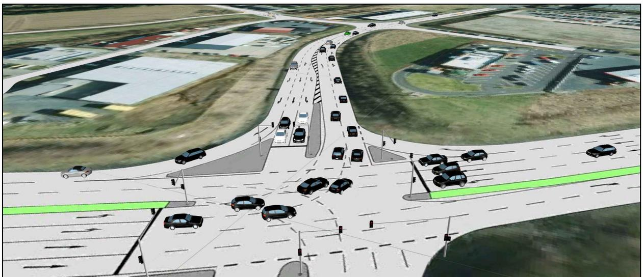
Abbildung 46: Screenshot aus der Simulation - Überprüfung der Verflechtungsvorgänge im Zuge der L 333
