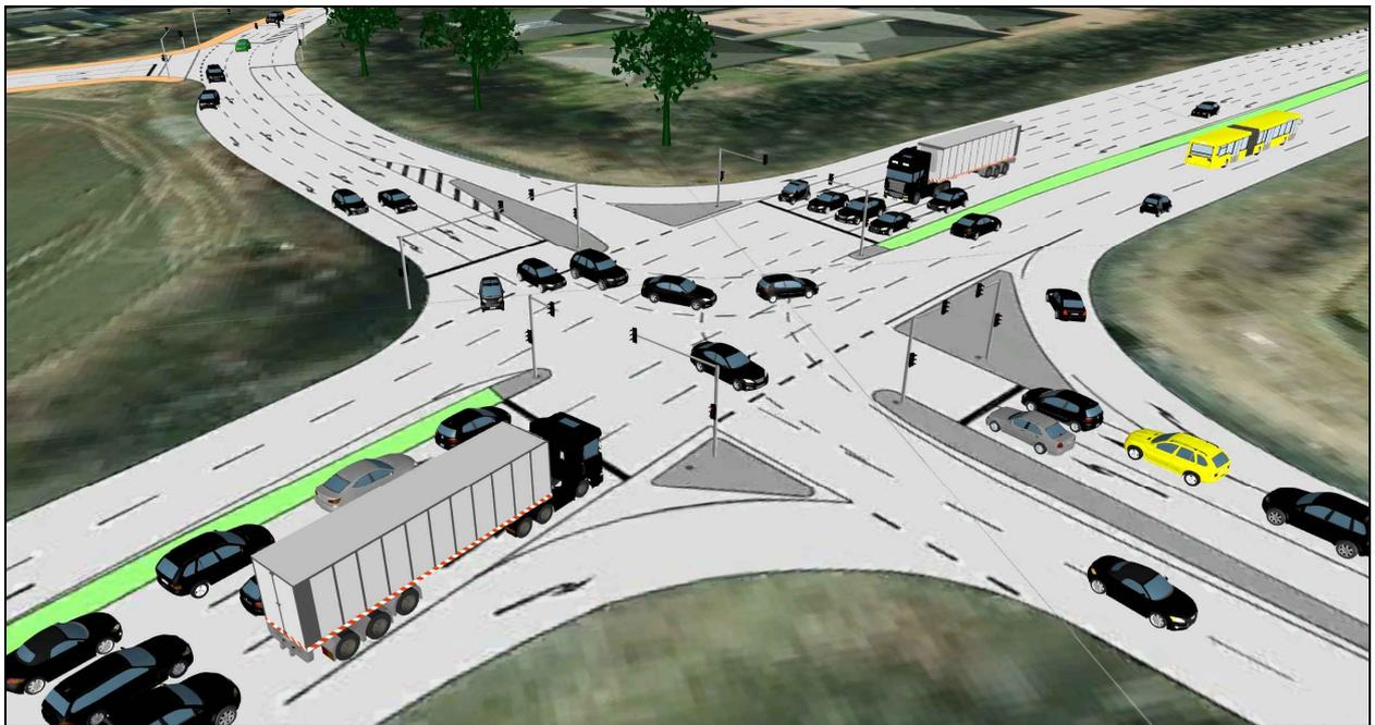
Abbildung 78: Screenshot aus der Simulation - Signalisierungskonzept mit getrennter Freigabe der Nebenrichtungen
