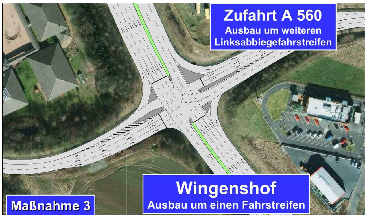
Abbildung 56: Bau von je einem weiteren Fahrstreifen am Ende der A 560 und in der Zufahrt Wingenshof
