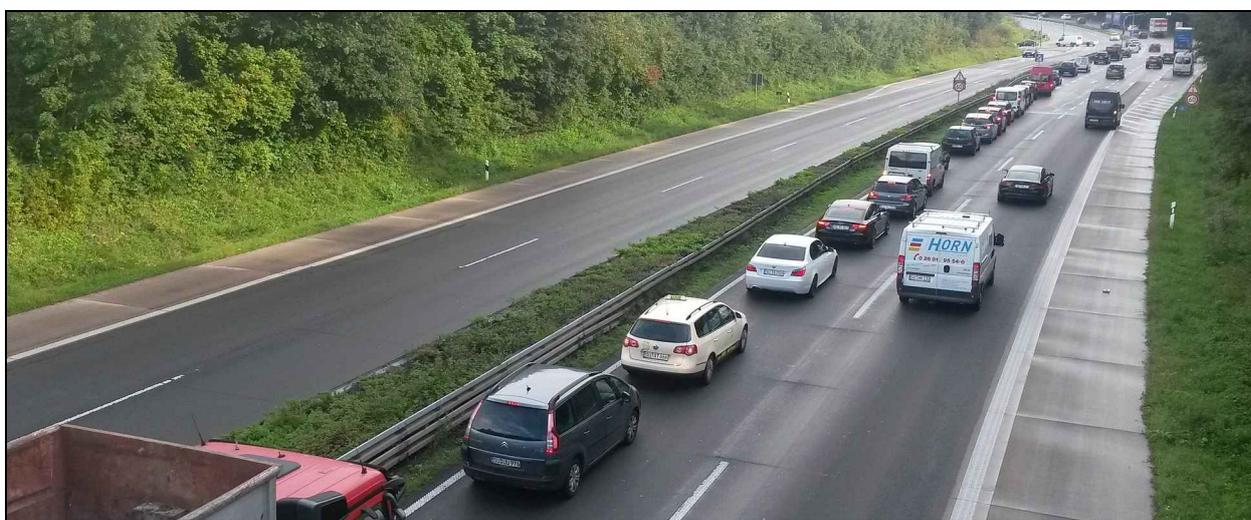
Abbildung 22: Rückstau vom Linksabbiegefahrstreifen am Autobahnenende der A 560 bis auf die Hauptfahrbahn
