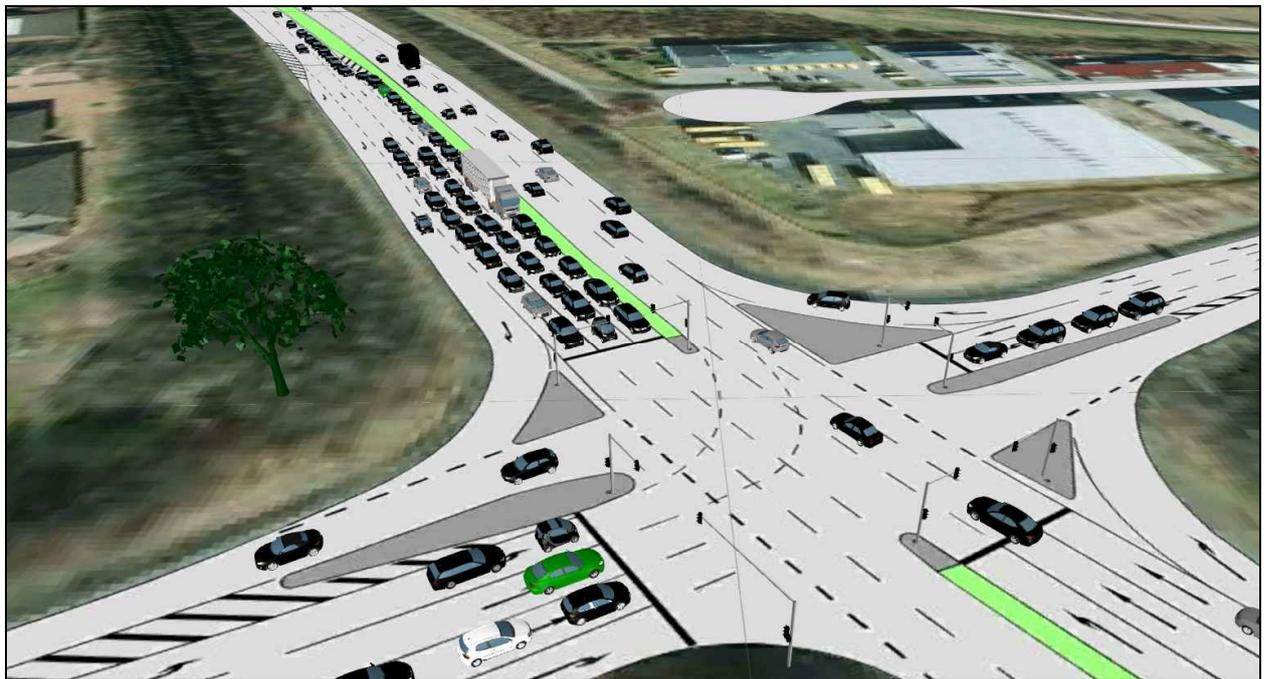
Abbildung 52: Screenshot aus der Simulation - Überstauung des Linksabbiegefahrstreifens am Ende der A 560
