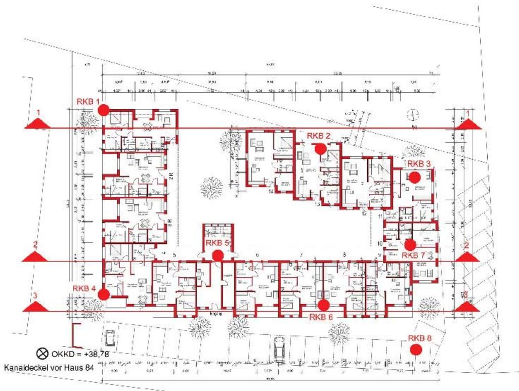
Die geotechnisch relevante Bauwerkshöhe OKF EG =  $\pm 0,00$  ist auf NN +39,75 m geplant (Planungstand Juni 2017).
