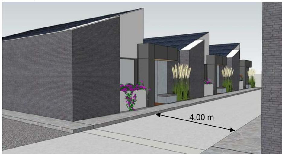
Die **Stichwege** mit einer Breite von 4,00 m enden in einer kleinen Platz- und Kommunikationsflächen, innerhalb einer ein- bis zweigeschossigen Bebauung. Die Fläche soll als Kommunikations- und Freifläche gestaltet werden.
