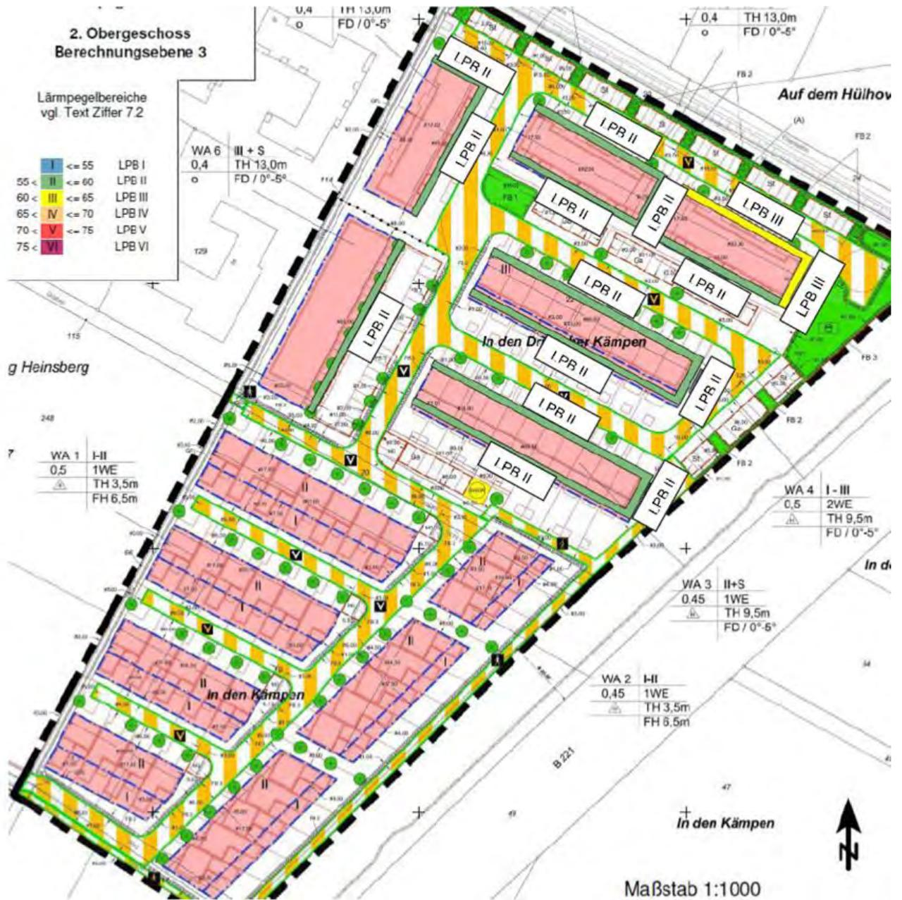
Abb. 6: Schalltechnische Maßnahmen, Lärmpegelbereiche 2. Obergeschoss
