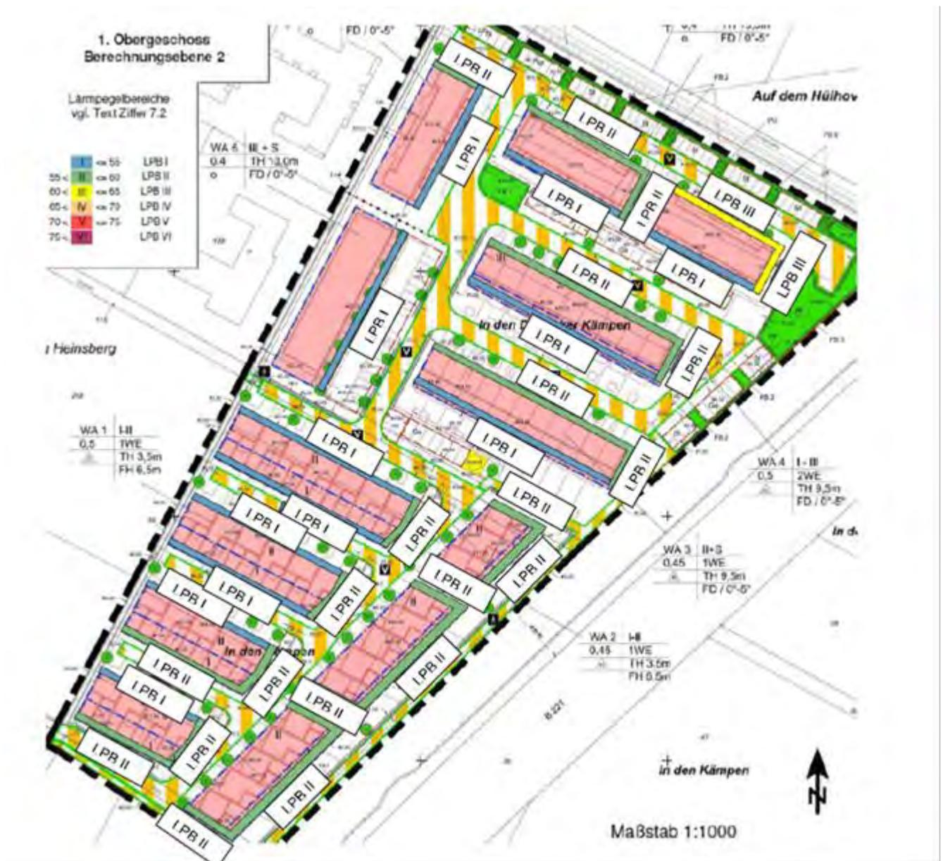
Abb. 5: Schalltechnische Maßnahmen, Lärmpegelbereiche 1. Obergeschoss
