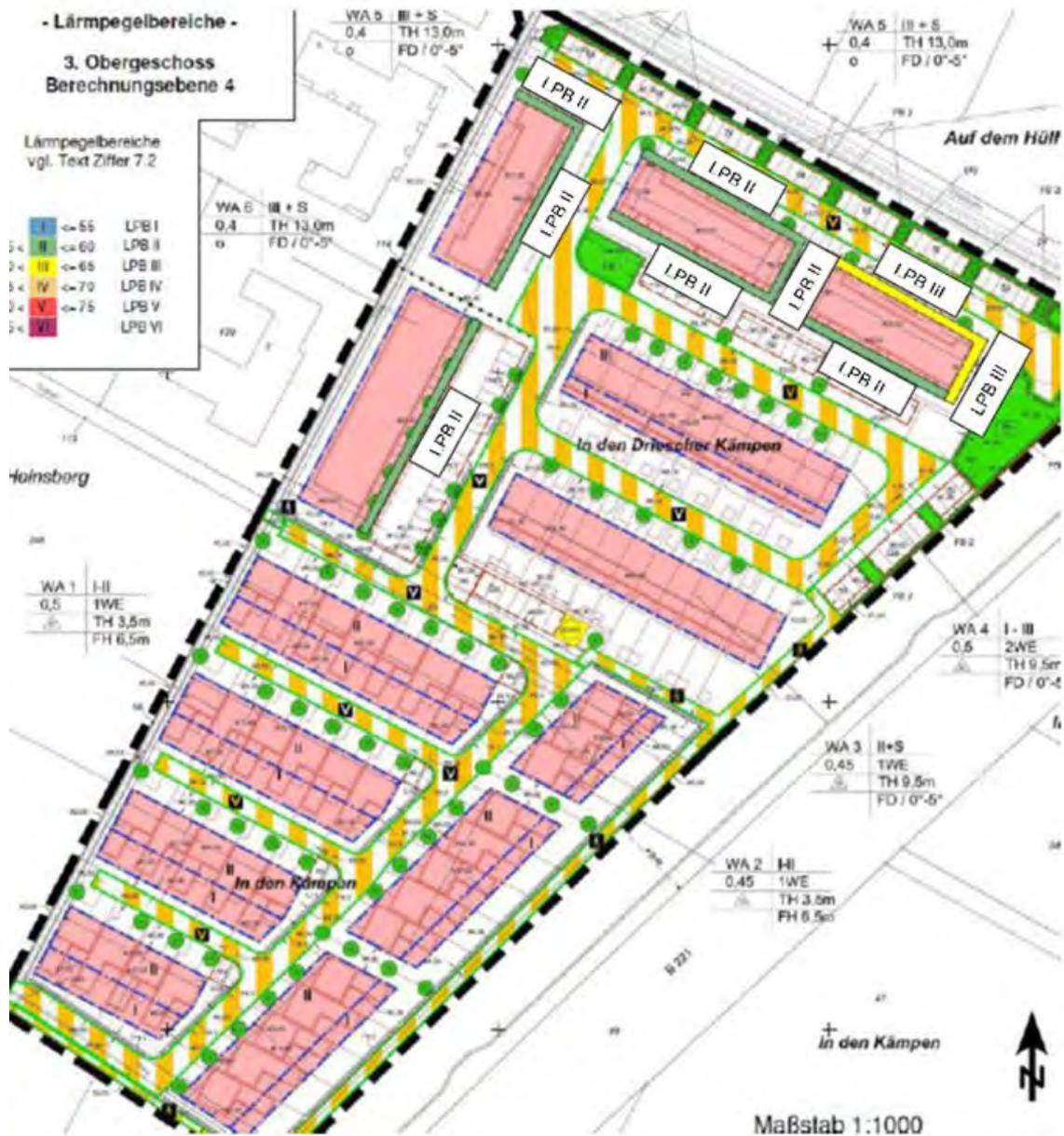
Abb. 7: Schalltechnische Maßnahmen, Lärmpegelbereiche 3. Obergeschoss
