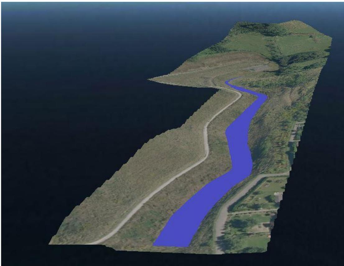
Abb. 22: Rückstau bei einer Einstauhöhe von 144,85 müNN
