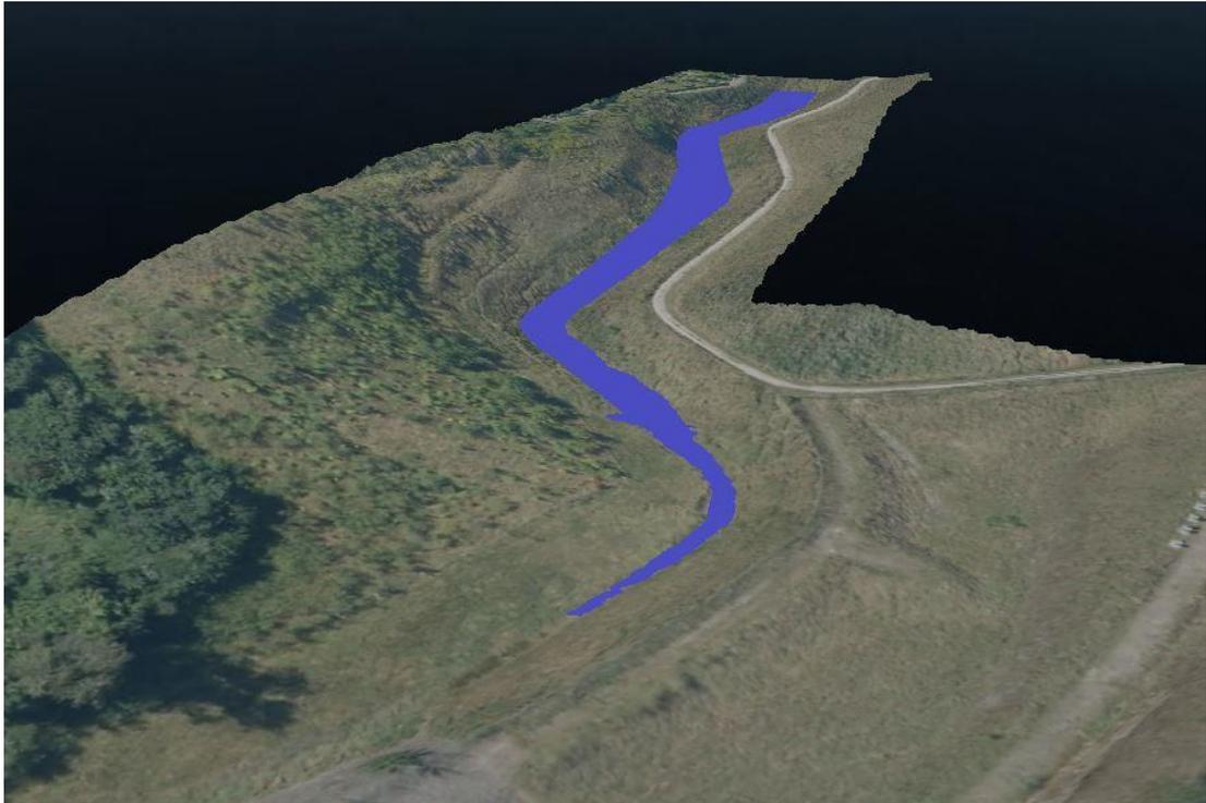
Abb. 23: Rückstau bei einer Einstauhöhe von 144,85 müNN
