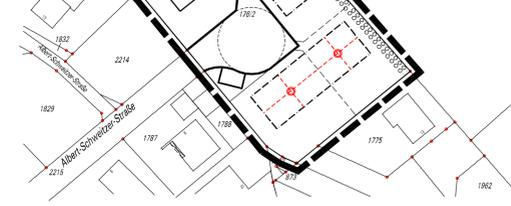
**Definition:** Der untere Bezugspunkt für die Höhenmaße ist die Höhe der natürlichen Geländeoberfläche (§ 2(4) BauO NRW) gemessen im Schnittpunkt der geometrischen Mittellinien der überbaubaren Grundstücksfläche eines Baugrundstückes.
