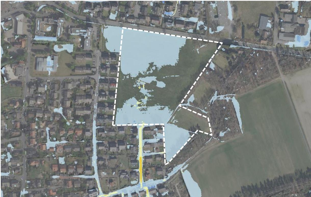
Abbildung 7: Starkregengefahrenhinweiskarte NRW: Wasserhöhen extremes Ereignis, ohne Maßstab (Geodaten NRW)
