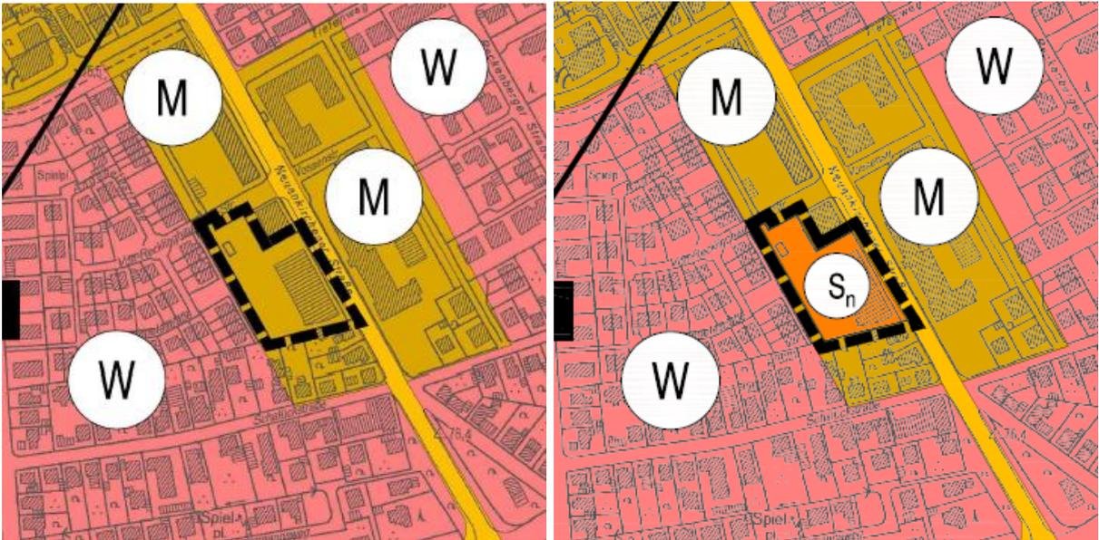
Abbildung 5: Auszug aus dem bestehenden FNP (links) sowie der Darstellung der 12. Änderung (rechts) der Stadt Gütersloh. W = Wohnbaufläche, M = Gemischte Baufläche, S<sub>n</sub> = Sonderbaufläche (n = großflächiger Einzelhandel: Nahversorgung) (STADT GÜTERSLOH 2020).
