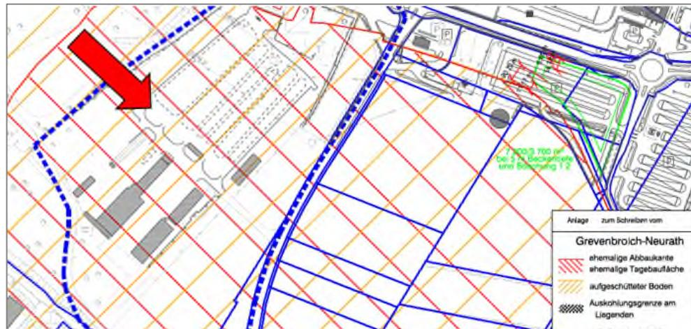
**Abb. 1: Abbaukante und Verfüllungsbereich des ehem. Tagebaus**
