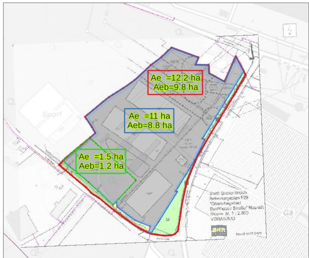
**Abb. 3: Entwässerungsfläche mit einer möglichen Entwicklungsoption**
