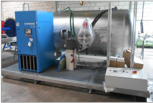
**Abb. 10: Anlagentechnik Hydroburst**
