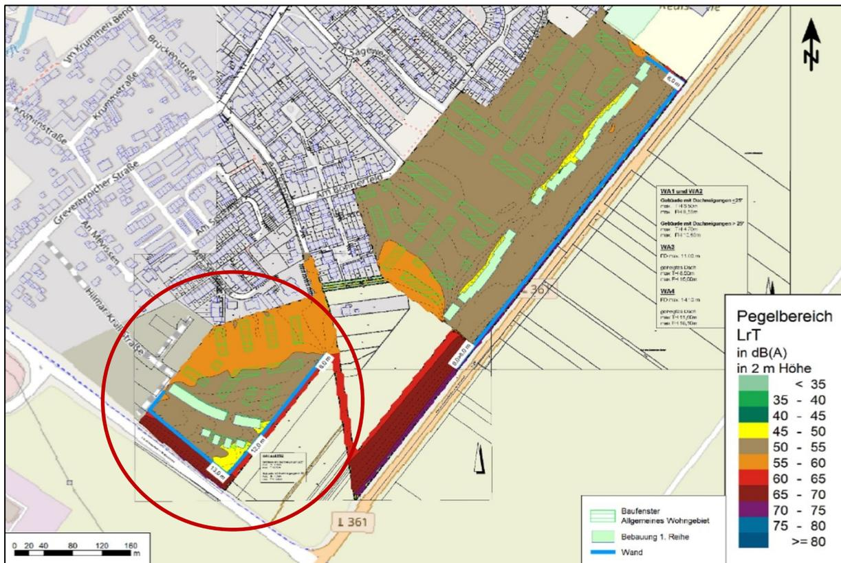
Abbildung 10: Beurteilungspegel Außenbereiche mit Lärmschutzwand (Zielwert 55 dB(A)) – TAC 2022
