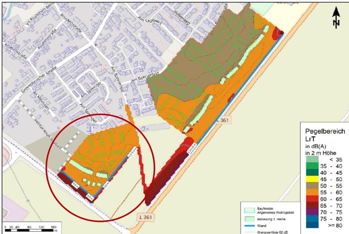
Abbildung 11: Beurteilungspegel Außenbereiche mit Schallschutzwand (Zielwert 60 dB(A)) – TAC 2022
