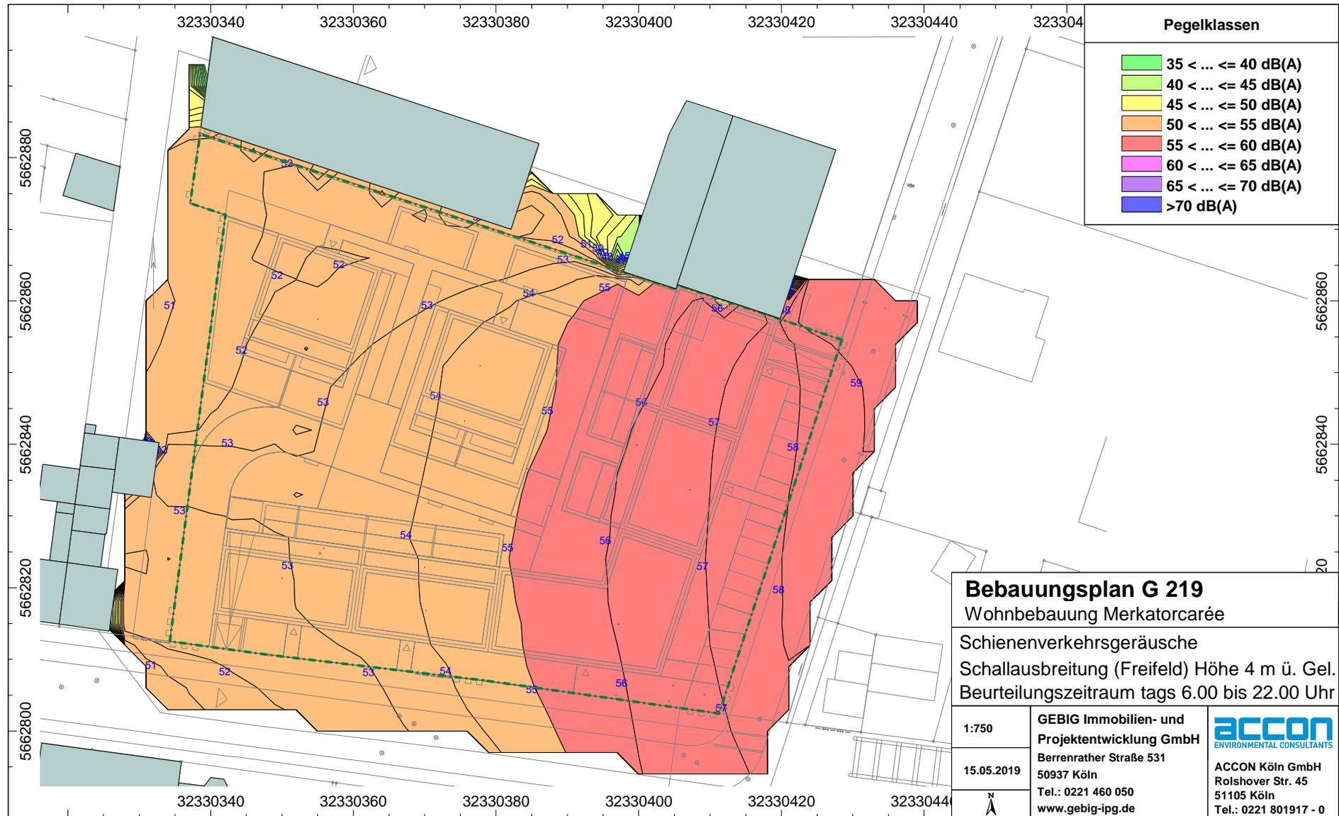
Abb. 4.3.1.1 Schienenverkehrslärmimmissionen in Höhe des Erdgeschosses (Freifeld) tags
