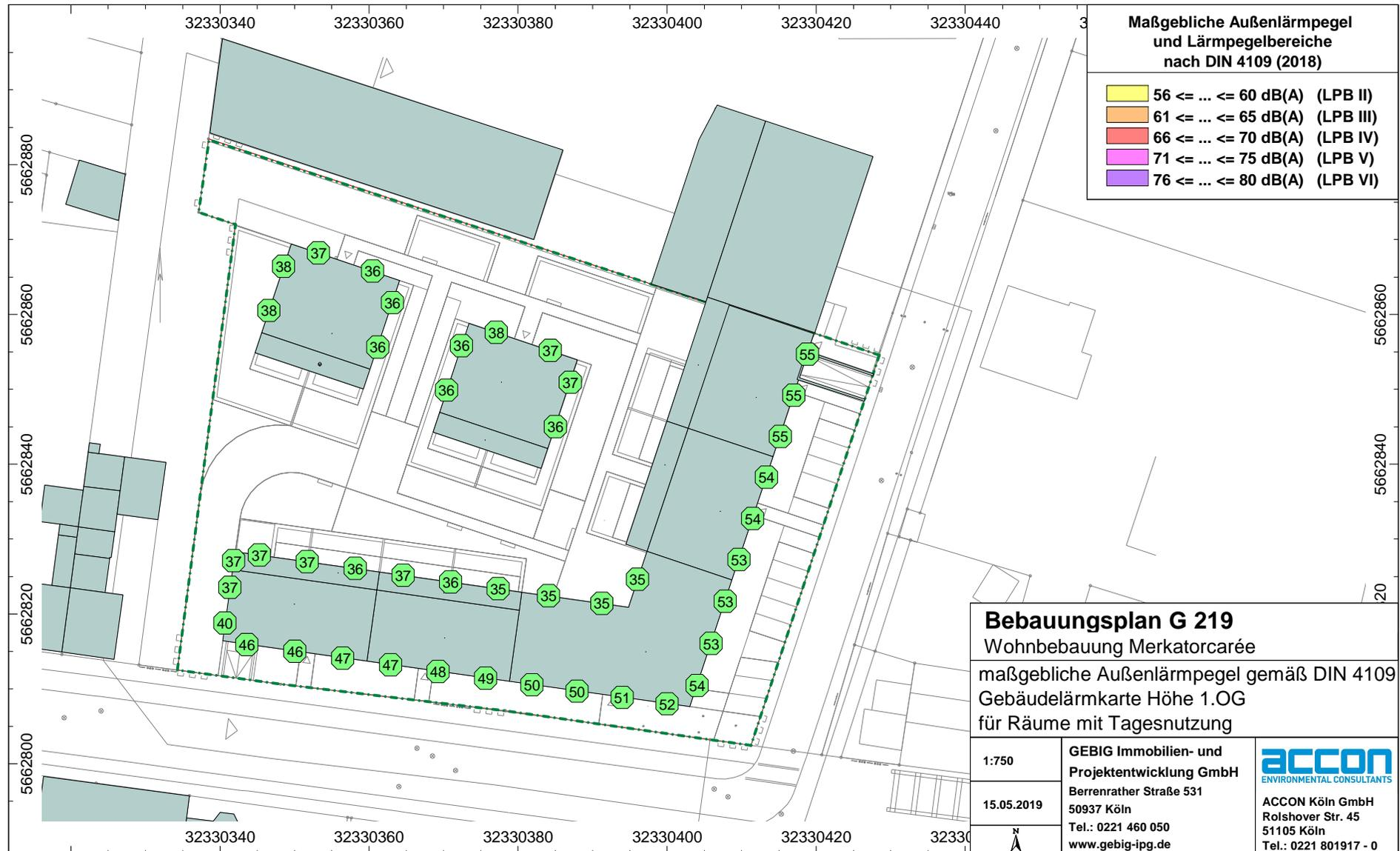
**Abb. 5.4** maßgebliche Außenlärmpegel und Lärmpegelbereiche nach DIN 4109 für das erste OG - Bebauung gemäß Konzeptentwurf - Räume mit Tagesnutzung
