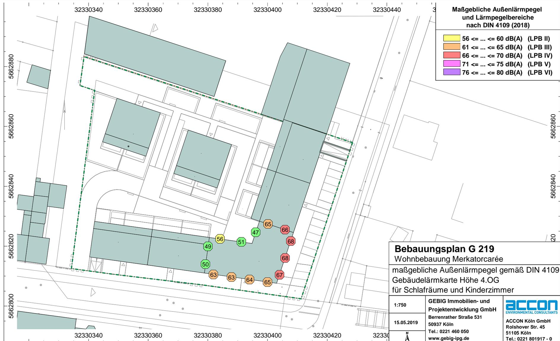
**Abb. 5.12** maßgebliche Außenlärmpegel und Lärmpegelbereiche nach DIN 4109 für das vierte OG - Bebauung gemäß Konzeptentwurf - zum Schutz des Nachtschlafs
