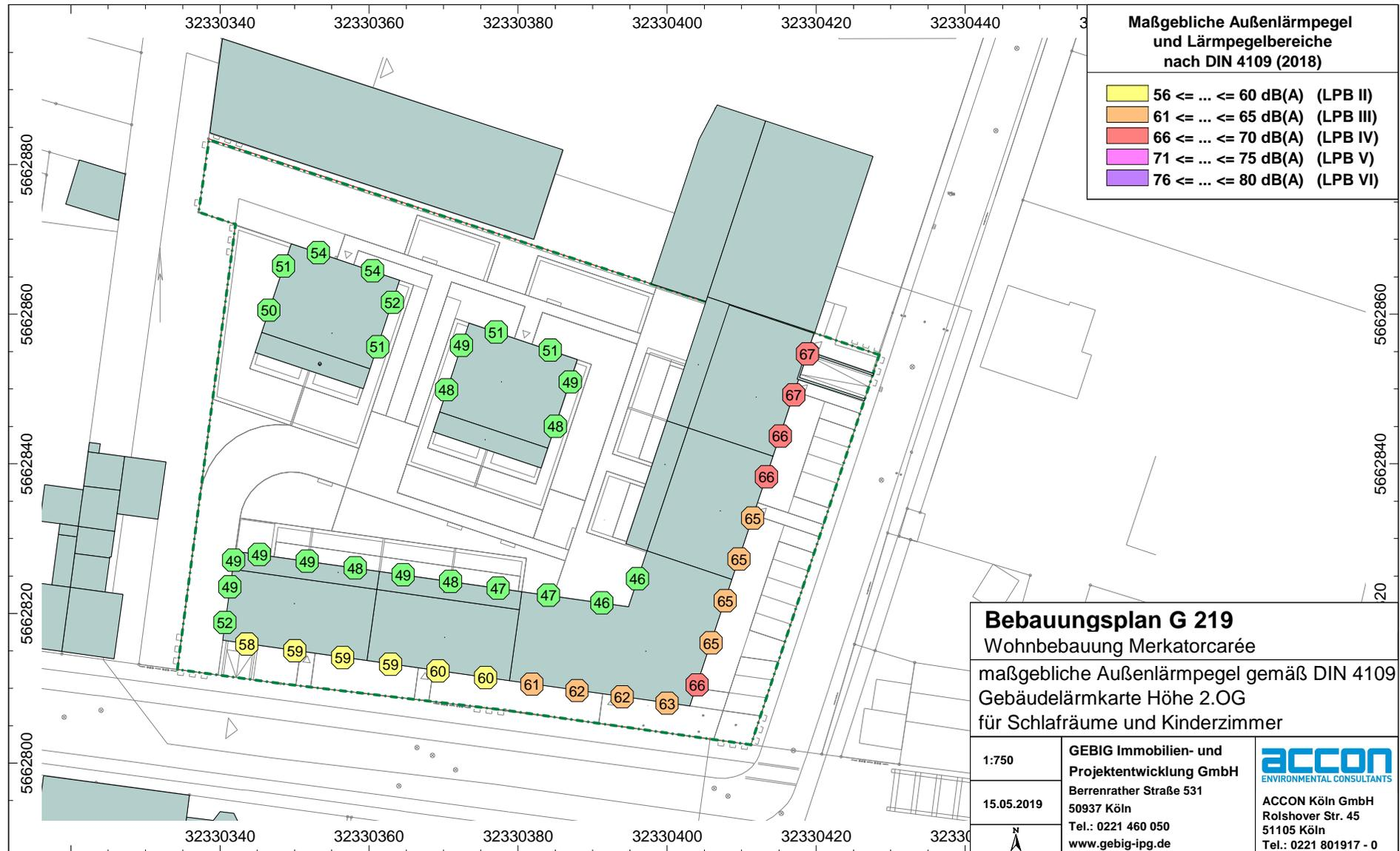
**Abb. 5.10** maßgebliche Außenlärmpegel und Lärmpegelbereiche nach DIN 4109 für das zweite OG - Bebauung gemäß Konzeptentwurf - zum Schutz des Nachtschlafs
