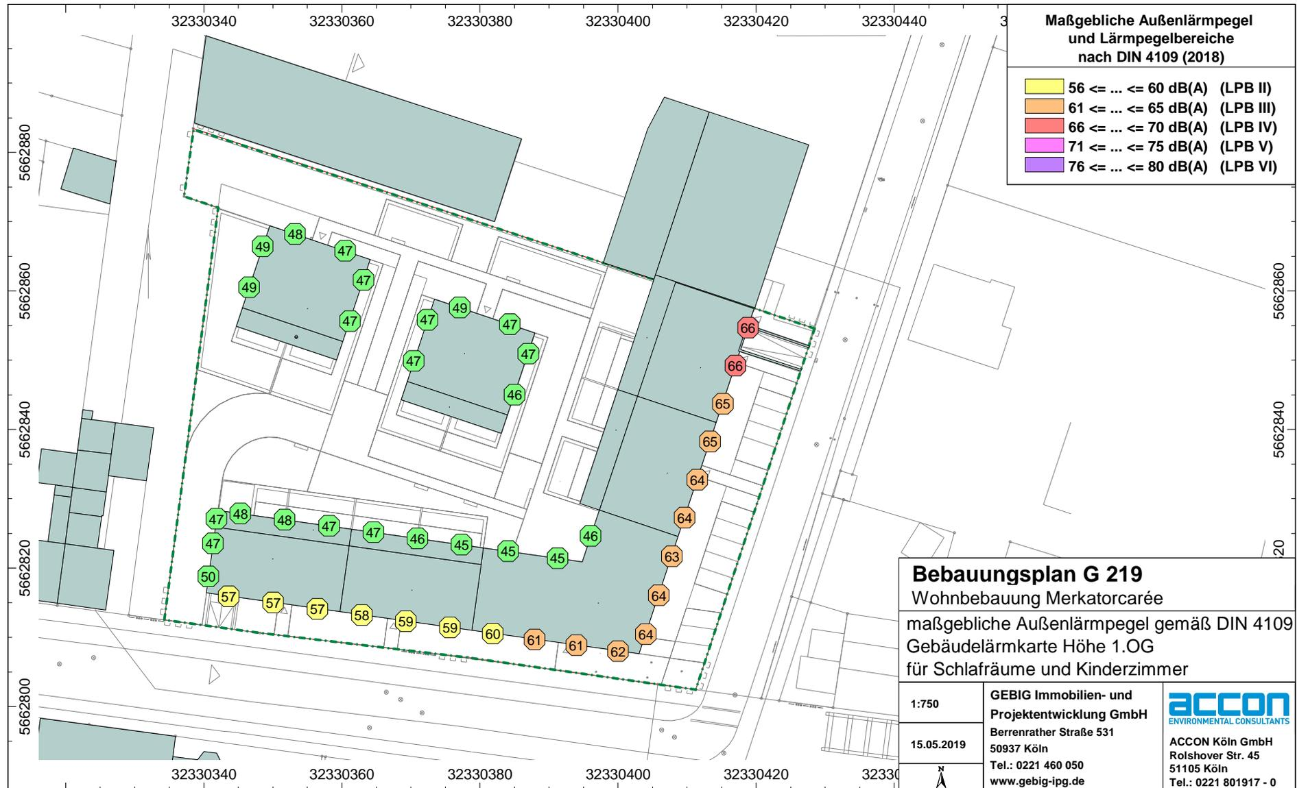
**Abb. 5.9** maßgebliche Außenlärmpegel und Lärmpegelbereiche nach DIN 4109 für das erste OG - Bebauung gemäß Konzeptentwurf - zum Schutz des Nachtschlafs
