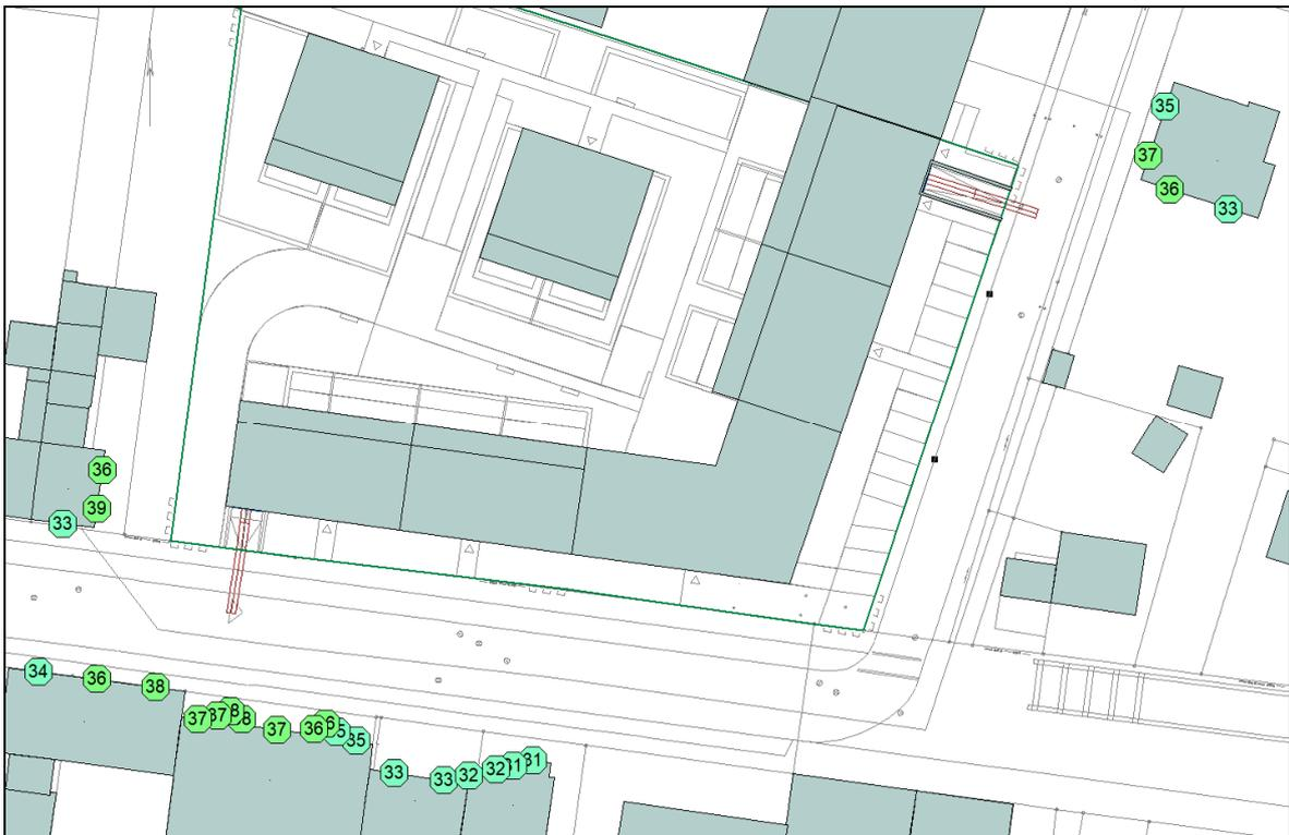
**Abb. 6.1** Beurteilungspegel durch die Nutzung der Tiefgaragenanbindungen tags
