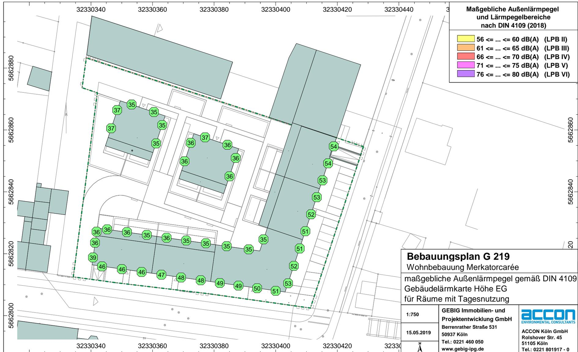
**Abb. 5.3** maßgebliche Außenlärmpegel und Lärmpegelbereiche nach DIN 4109 für das Erdgeschoss - Bebauung gemäß Konzeptentwurf - Räume mit Tagesnutzung
