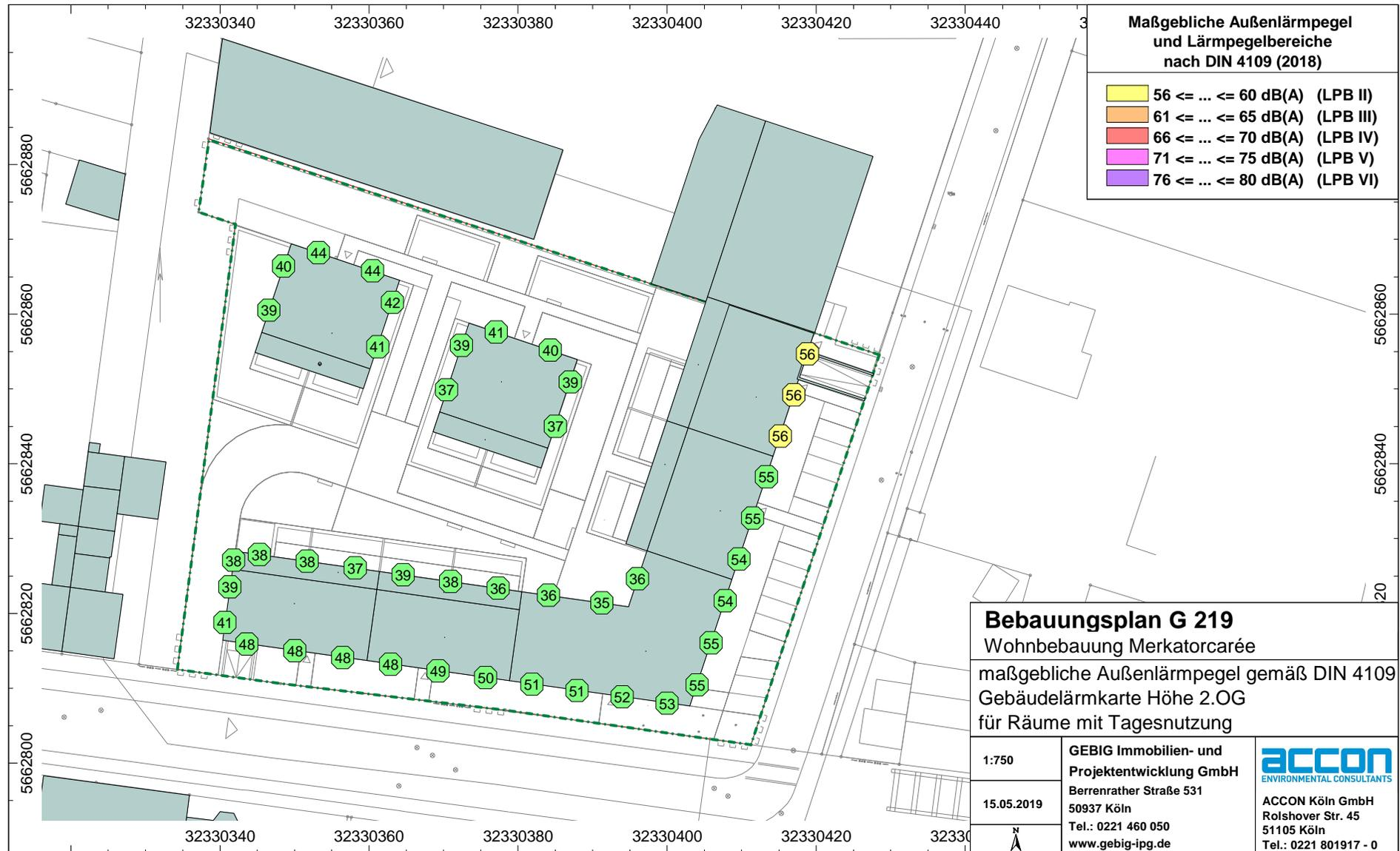
**Abb. 5.5** maßgebliche Außenlärmpegel und Lärmpegelbereiche nach DIN 4109 für das zweite OG - Bebauung gemäß Konzeptentwurf - Räume mit Tagesnutzung
