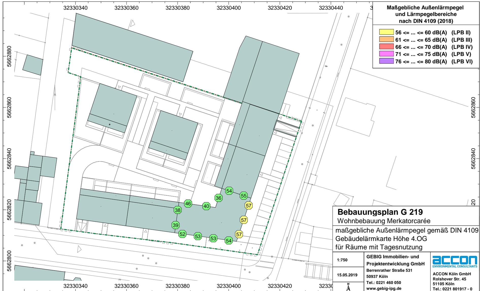
**Abb. 5.7** maßgebliche Außenlärmpegel und Lärmpegelbereiche nach DIN 4109 für das vierte OG - Bebauung gemäß Konzeptentwurf - Räume mit Tagesnutzung
