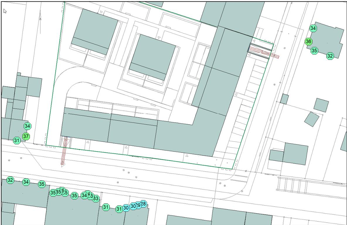
**Abb. 6.2** Beurteilungspegel durch die Nutzung der Tiefgaragenanbindungen lauteste Nachtstunde
