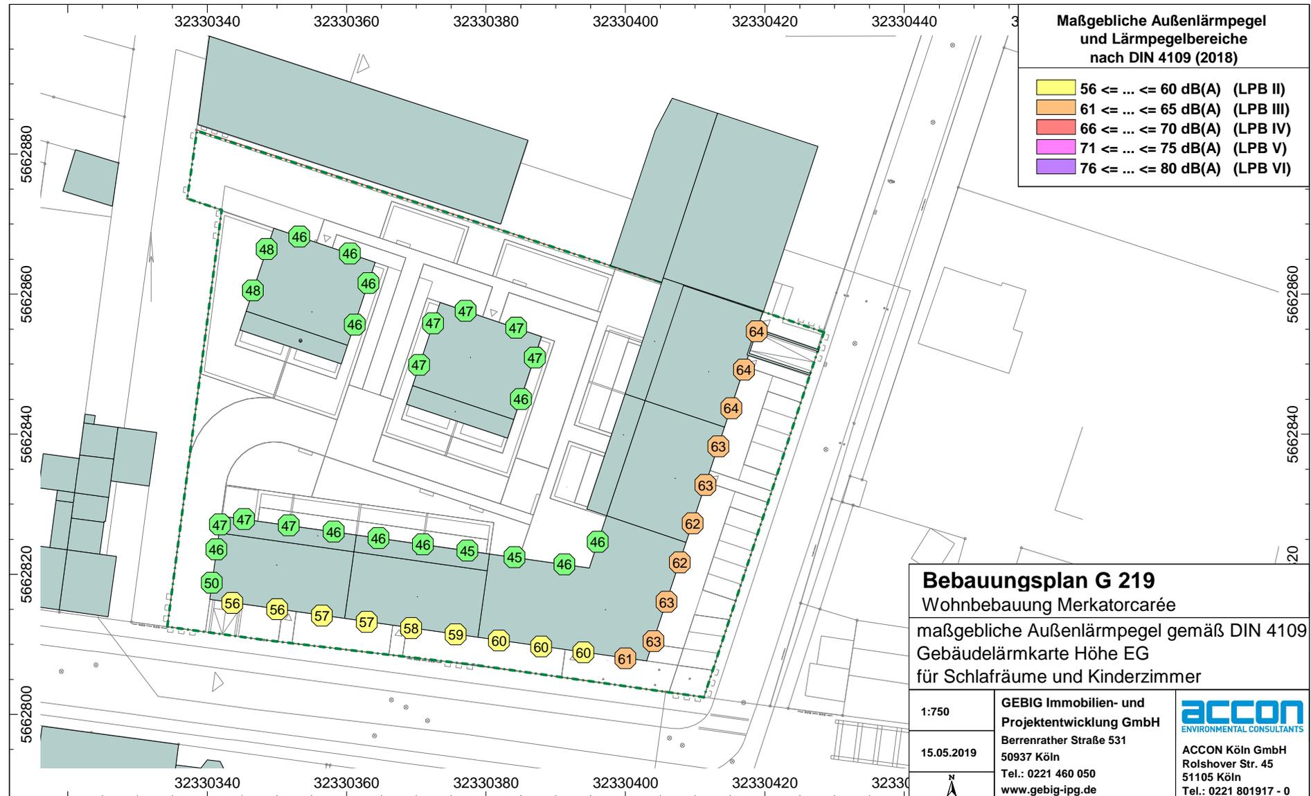
**Abb. 5.8** maßgebliche Außenlärmpegel und Lärmpegelbereiche nach DIN 4109 für das Erdgeschoss - Bebauung gemäß Konzeptentwurf - zum Schutz des Nachtschlafs
