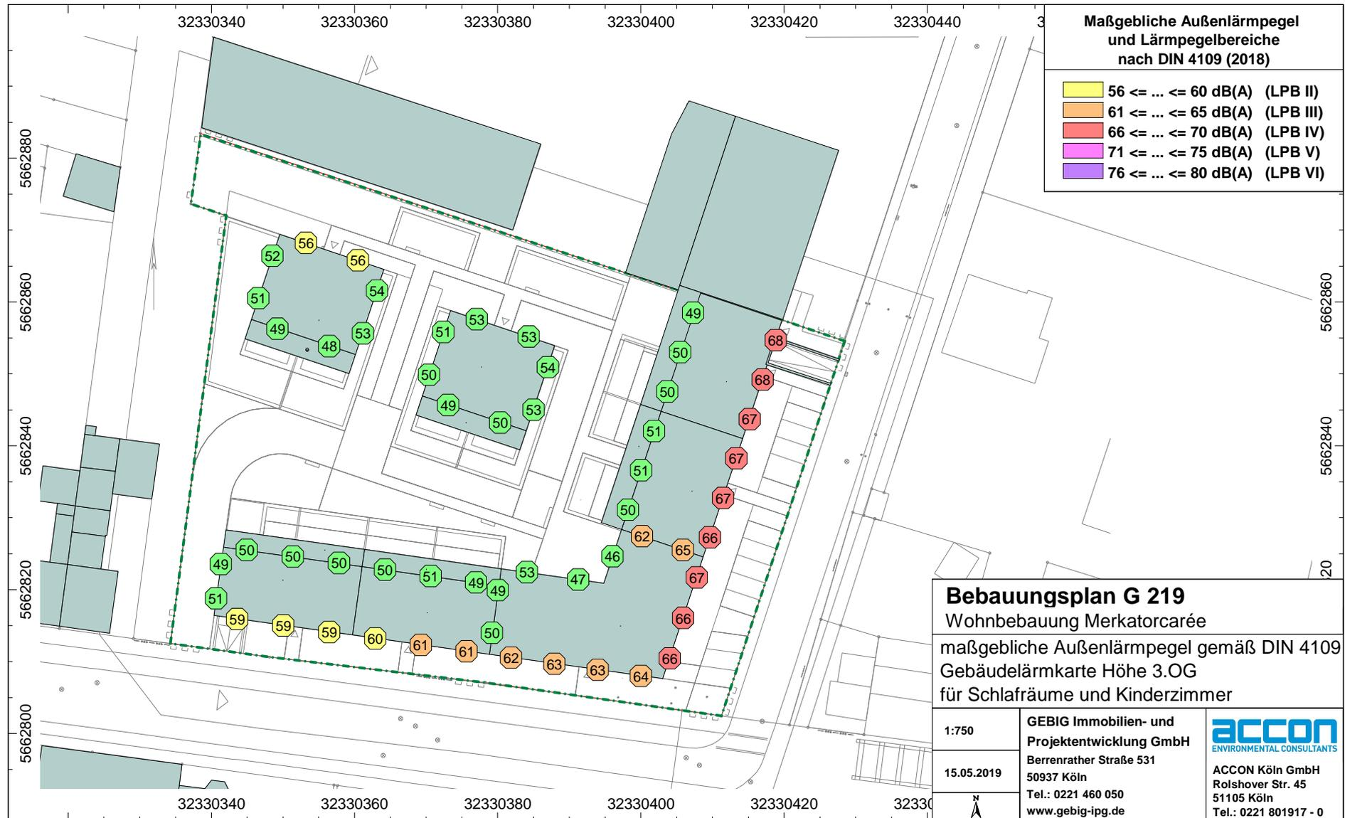
**Abb. 5.11** maßgebliche Außenlärmpegel und Lärmpegelbereiche nach DIN 4109 für das dritte OG - Bebauung gemäß Konzeptentwurf - zum Schutz des Nachtschlafs
