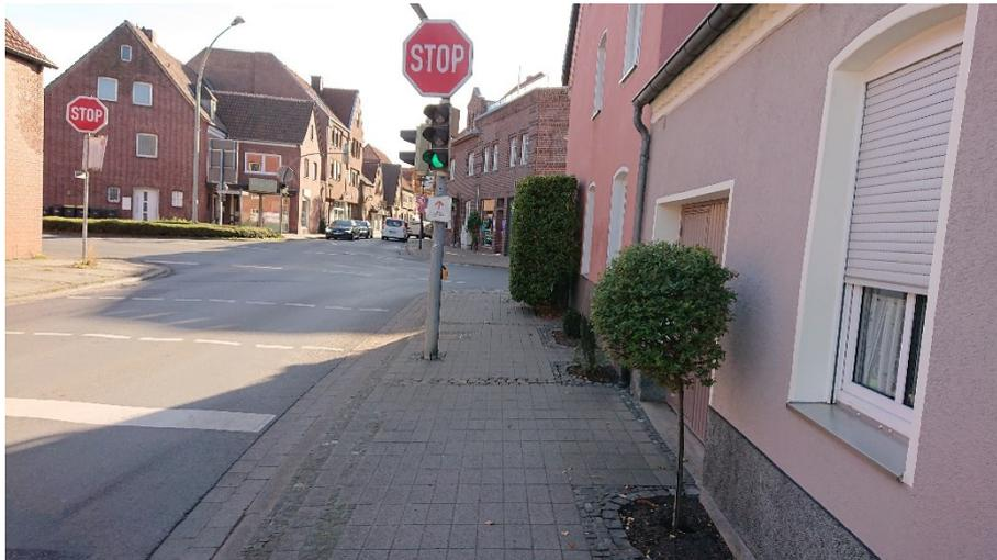
Abbildung 4: Engstelle für den Fußverkehr durch Bepflanzung im Bestand
