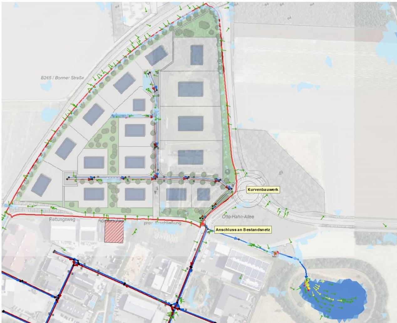
Abb. 6-3: Ausschnitt Modellregen  $T_n = 30$  a mit  $D = 60$  min, BP 210 mit Versickerungsanlage
