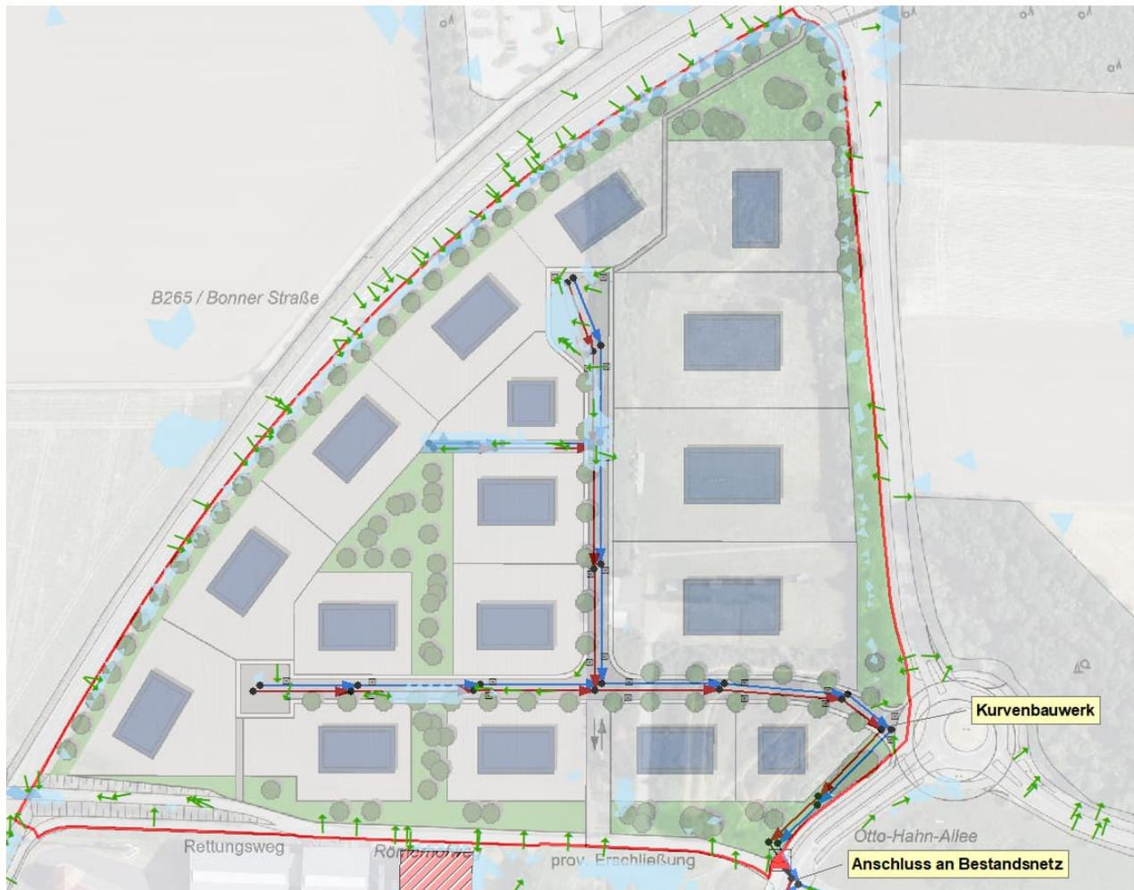
Abb. 6-2: Ausschnitt Modellregen  $T_n = 30$  a mit  $D = 60$  min, BP 210
