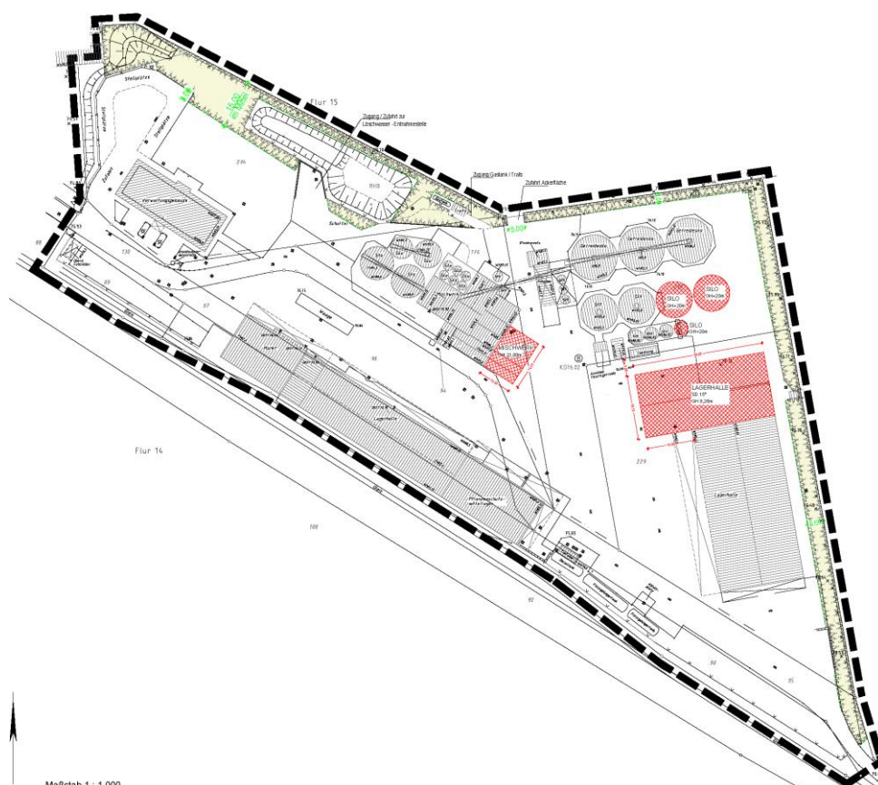
Abb. 1: Vorhaben- und Erschließungsplan zum vorhabenbezogenen Bebauungsplan „Am Bahnhof“, 1. Änderung (Stand Juli 2020, verkleinert, ohne Maßstab; rot: geplante bauliche Anlagen, Quelle: Architekturbüro Sickmann, Warendorf-Hoetmar) – Der Originalplan ist bei der Stadt Ennigerloh, Fachbereich Stadtplanung einsehbar.
