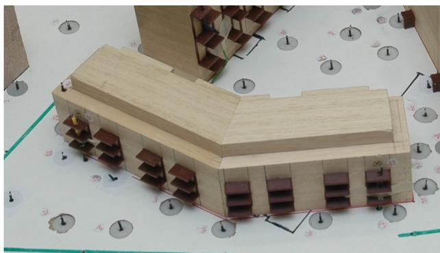
Bild 5.9: Photo des Windkanalmodells für den Bereich Bauteil D
