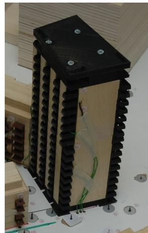
Bild 5.5: Photo des Windkanalmodells für den Bereich Bauteil B
