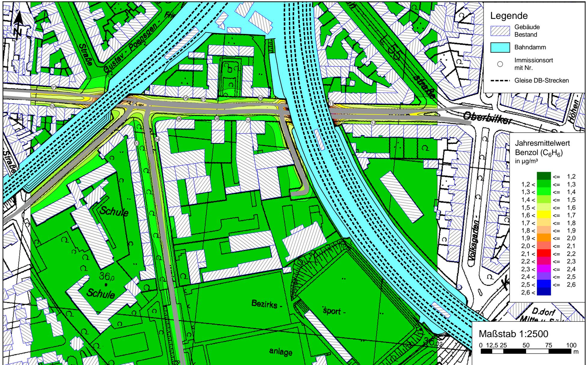
Benzol ( $C_6H_6$ ) Gesamtbelastung (Jahresmittelwert, Bodennähe  $h=1,5m$ ) für den "Planfall 2016" für den Bebauungsplan Nr. 03/001 - Oberbilker Allee / Ringelsweide mit einer Hintergrundbelastung von  $1,2 \mu g/m^3$ ; Grenzwert ( $C_6H_6$ ):  $5,0 \mu g/m^3$
