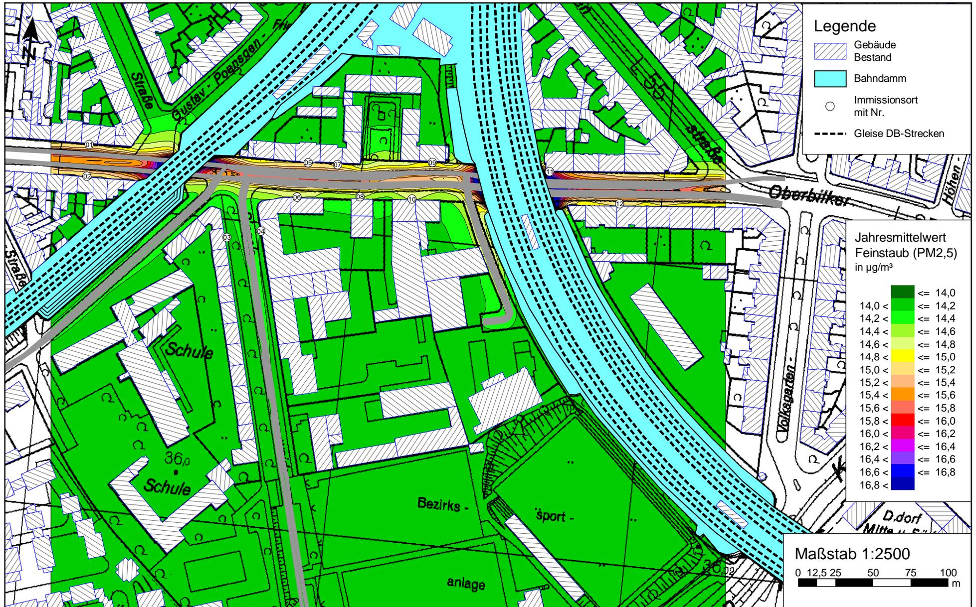
Feinstaub (PM<sub>2,5</sub>) Gesamtbelastung (Jahresmittelwert, Bodennähe h=1,5m) für den "Nullfall 2016" für den Bebauungsplan Nr. 03/001 - Oberbilker Allee / Ringelsweide mit einer Hintergrundbelastung von 15,5 µg/m<sup>3</sup>; Grenzwert (PM<sub>2,5</sub>): 25,0 µg/m<sup>3</sup>
