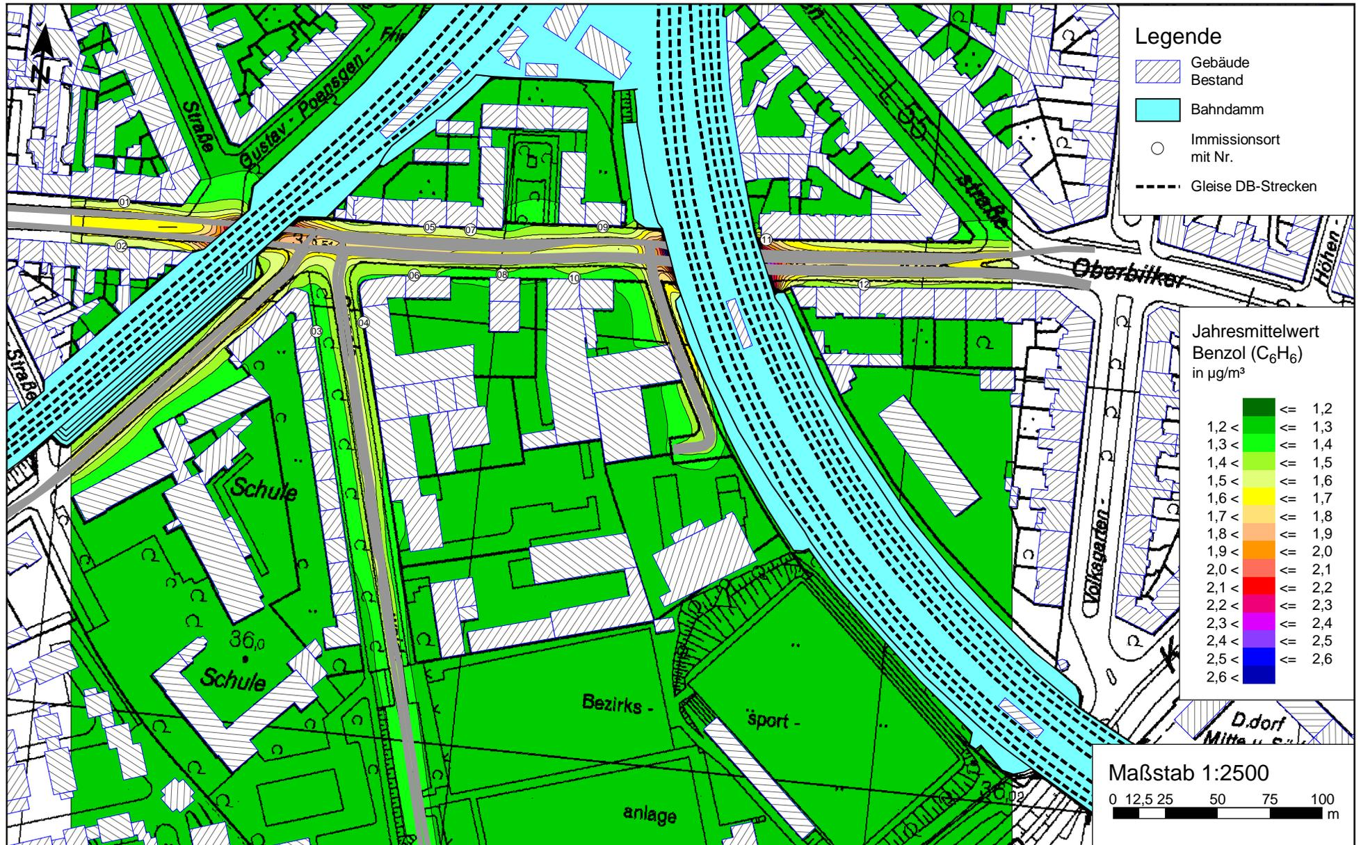
Benzol ( $C_6H_6$ ) Gesamtbelastung (Jahresmittelwert, Bodennähe  $h=1,5m$ ) für den "Nullfall 2016" für den Bebauungsplan Nr. 03/001 - Oberbilker Allee / Ringelsweide mit einer Hintergrundbelastung von  $1,2 \mu g/m^3$ ; Grenzwert ( $C_6H_6$ ):  $5,0 \mu g/m^3$
