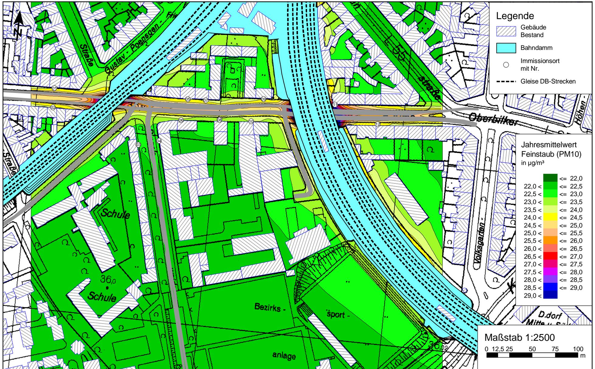
Feinstaub (PM10) Gesamtbelastung (Jahresmittelwert, Bodennähe h=1,5m) für den "Planfall 2016" für den Bebauungsplan Nr. 03/001 - Oberbilker Allee / Ringelsweide mit einer Hintergrundbelastung von 22,0  $\mu\text{g}/\text{m}^3$ ; Grenzwert (PM10): 40,0  $\mu\text{g}/\text{m}^3$
