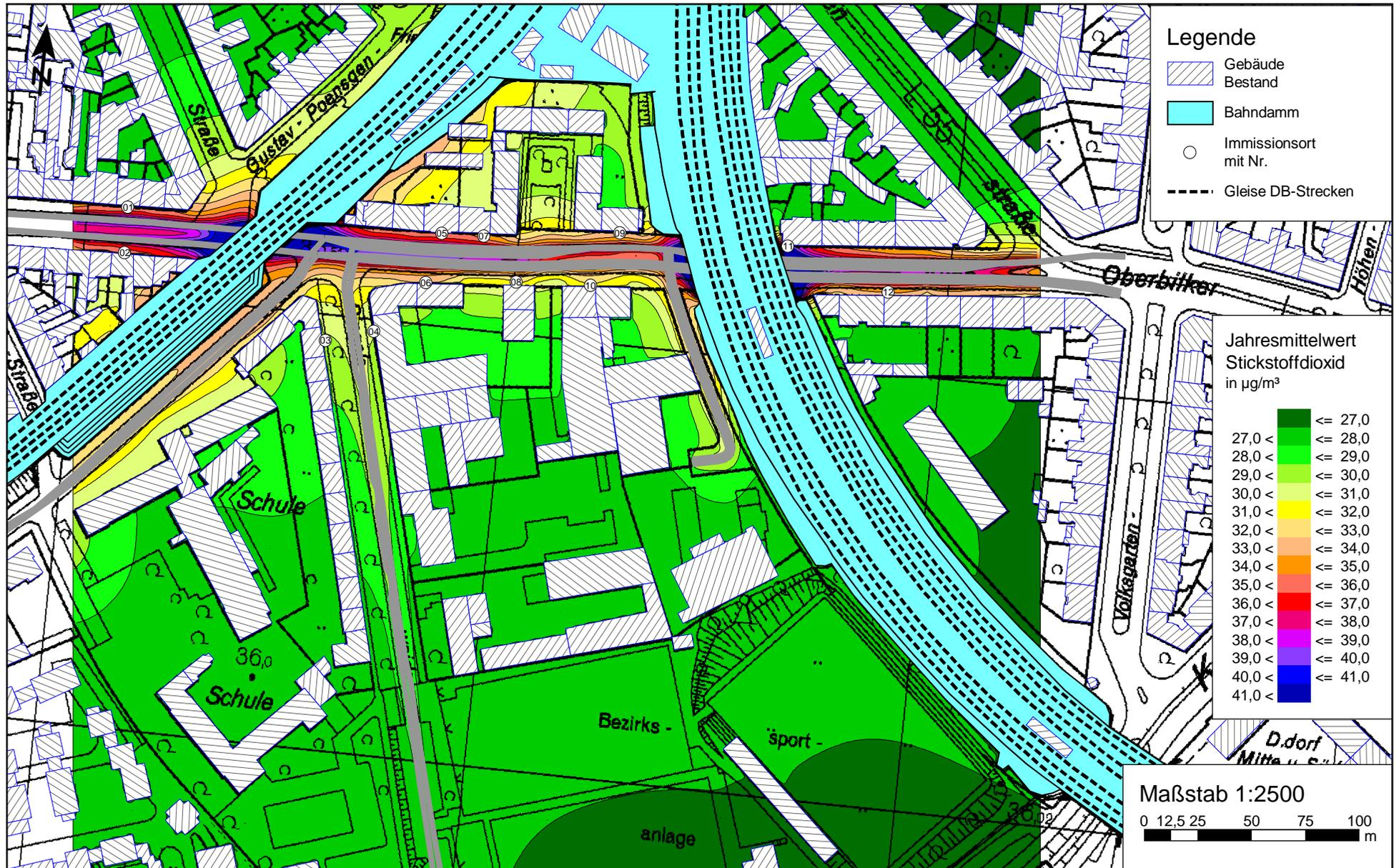
Stickstoffdioxid (NO<sub>2</sub>) Gesamtbelastung (Jahresmittelwert, Bodennähe h=1,5m) für den "Nullfall 2016" für den Bebauungsplan Nr. 03/001 - Oberbilker Allee / Ringelsweide mit einer Hintergrundbelastung von 24,8 µg/m<sup>3</sup>; Grenzwert (NO<sub>2</sub>): 40,0 µg/m<sup>3</sup>
