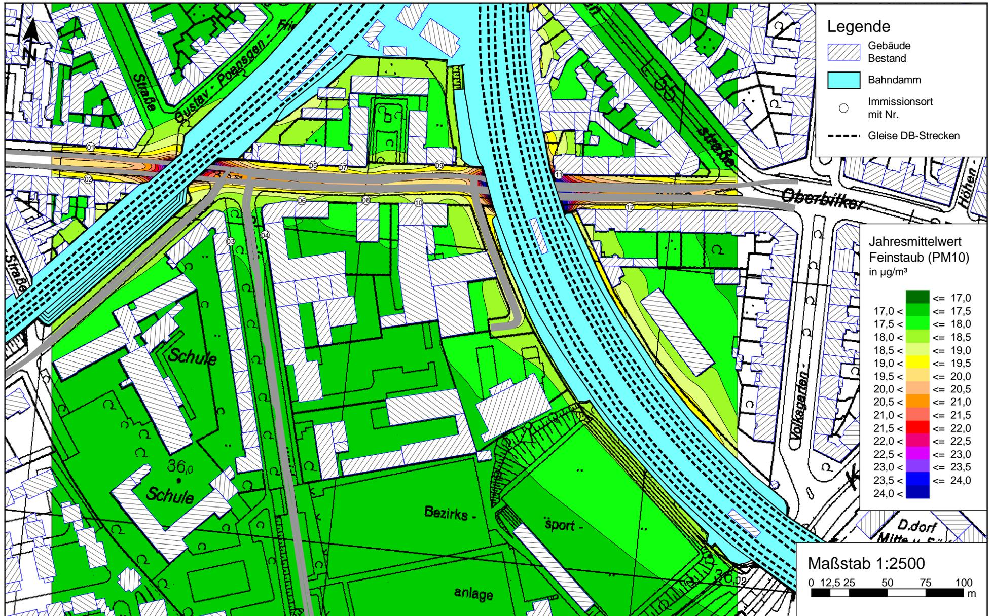
Feinstaub (PM10) Gesamtbelastung (Jahresmittelwert, Bodennähe h=1,5m) für den "Nullfall 2016" für den Bebauungsplan Nr. 03/001 - Oberbilker Allee / Ringelsweide mit einer Hintergrundbelastung von 22,0  $\mu\text{g}/\text{m}^3$ ; Grenzwert (PM10): 40,0  $\mu\text{g}/\text{m}^3$
