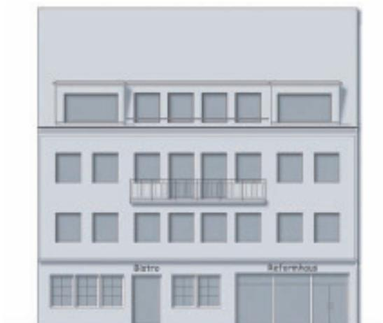
Die kleinmaßstäblichen, unterschiedlich großen Fassadenöffnungen im Erdgeschoss stören das Zusammenspiel von großflächigen Fenster- und Fassadenflächen. Der gestalterische Zusammenhang des Gebäudes ist gestört.
