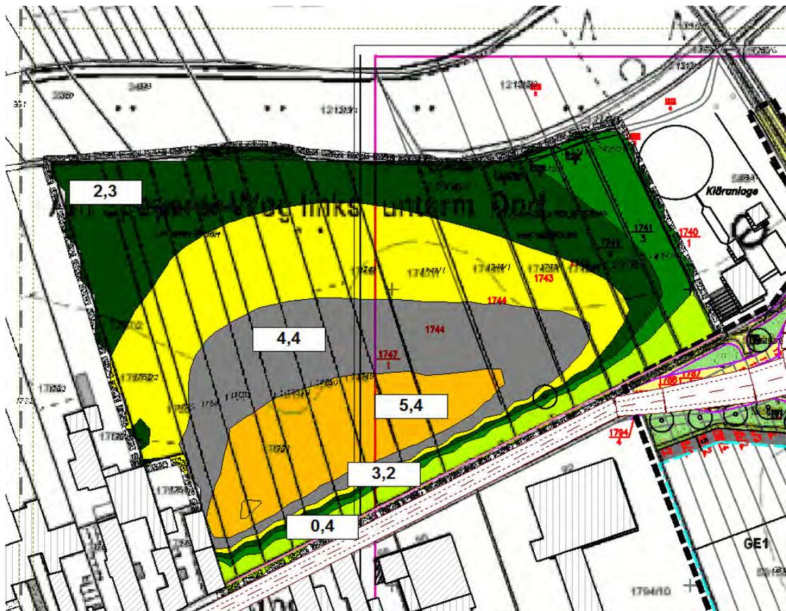
Bild 3: 6m über Gelände, Pegelminderung Straßenlärm mit durchgehender Wand H = 3m
