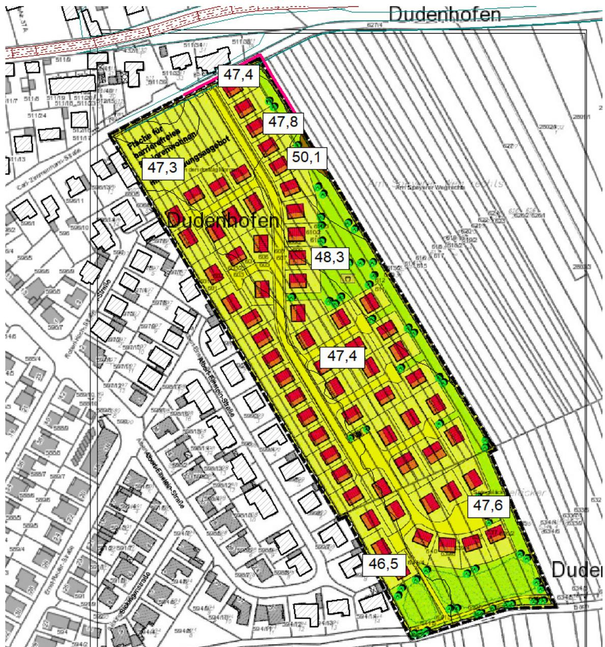
Bild 4: Ausschnitt aus dem digitalen Geländemodell, Beurteilungspegel Nachtzeitraum Verkehrslärm in 9m Höhe, Wandhöhe 10 Meter über Gelände.
