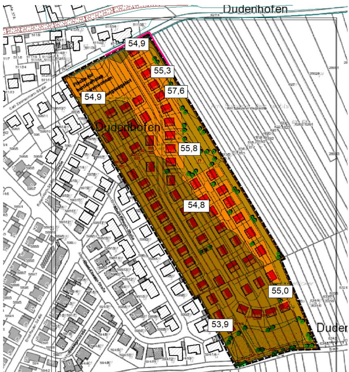
Bild 3: Ausschnitt aus dem digitalen Geländemodell, Beurteilungspegel Tagzeitraum Verkehrslärm in 9m Höhe, Wandhöhe 10 Meter über Gelände.
